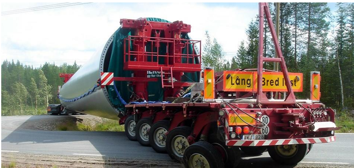
Figur 43. Transport av en torndel, svepning samt svängbara axlar. (BDX)
