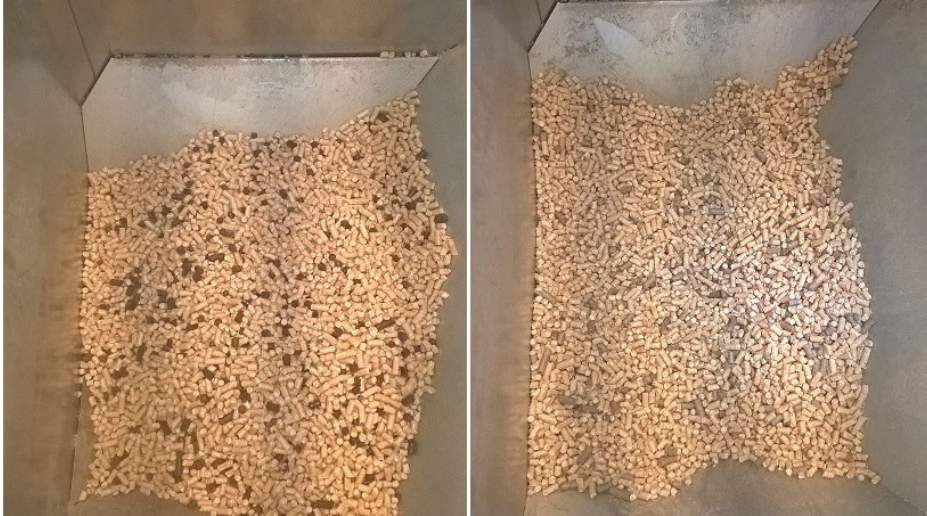
KUVA 5. Hevoslantapelletit 10 % seoksena valkoisten puupellettien kanssa pellettisiilossa. Vasemmalla turvepohjainen hevoslantapelletti ja oikealla kutteripohjainen hevoslantapelletti (kuvat Riikka Tanskanen 2016).
