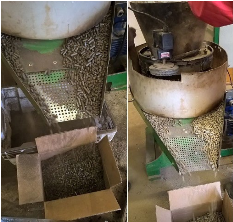
KUVA 2. Hevosenslantapellettien valmistusta tilaustyönä Jaakko Lomilla (Laitila). Vasemmalla turvepohjainen hevosenslantapelletti ja oikealla kutteripohjainen hevosenslantapelletti (kuvat Riikka Tanskanen 2016).
