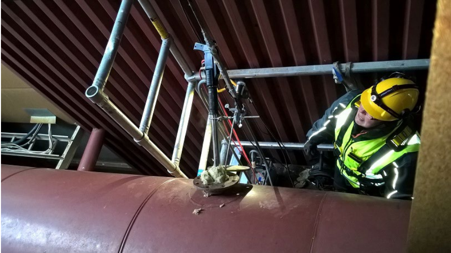
KUVA 4. Savukaasu- ja hiukkasmittauksen toteutusta Juvalla (kuva Riikka Tanskanen 2016).
