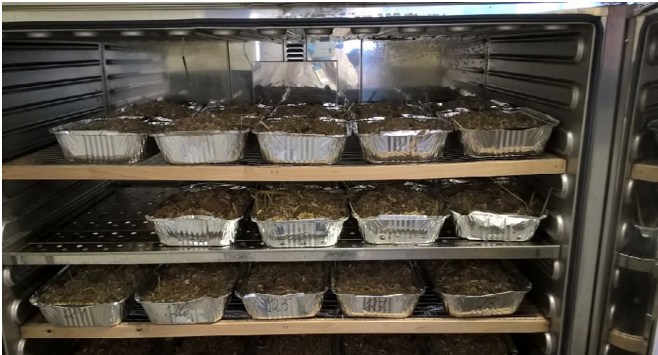
KUVA 4. Kosteuspitoisuuden määrittäminen unikuivausmenetelmällä SFS-EN 14774-2 standardin mukaisesti (kuva Riikka Tanskanen 2016).
