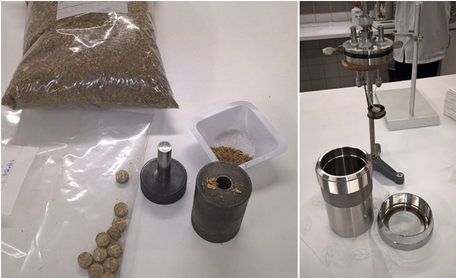
KUVA 11. Hevosenlantanäytteiden kalorimetrisen lämpöarvon analysointi Parr 6200 pommikalorimetrialaitteistolla. Vasemmalla kuvassa näytetablettien valmistusta kuivatusta ja jauhetusta hevosenlannasta. Oikealla kuvassa laitteiston varsinainen pommikammio, johon näytetabletti asetetaan analyysin suorittamiseksi (kuvat Riikka Tanskanen 2016).
