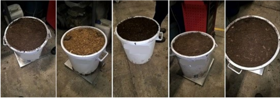
KUVA 3. Juvan lämpökeskuksella 31.10.2016–3.11.2016 käytetyt polttoaineet. Vasemmalta: puhdas jyrshinturpe, puhdas hevosenlanta, 10 % hevosenlantaseos, 15 % hevosenlantaseos ja 20 % hevosenlantaseos. (kuvat Riikka Tanskanen 2016).
