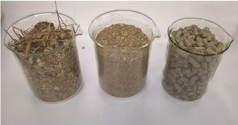
KUVA 1. Hevoselannan eri vaiheet pellettien valmistuksessa. Vasemmalla kuivattu kutteripohjainen hevoselanta, keskellä jauhettu kutteripohjainen hevoselanta ja oikealla kutteripohjainen hevoselantapelletti (kuva Riikka Tanskanen 2016).
