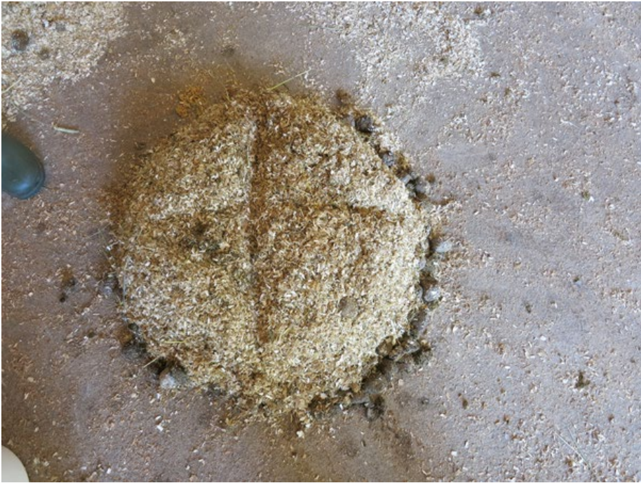
KUVA 1. Laboratorionäytteen valmistus hevosenlannan kokoomanäytteestä neliömällä SFS-EN 14780 standardin mukaisesti (kuva Jarno Föhr 2016).
