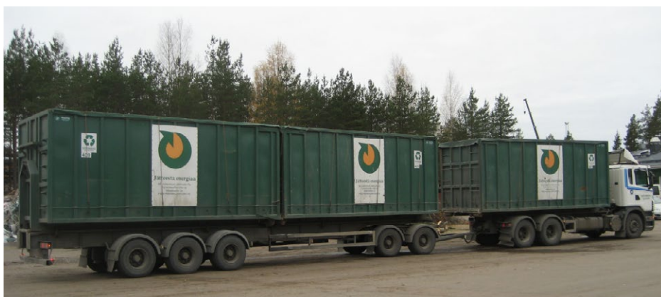
KUVA 1. Kolmen kontin vaihtolavayhdistelmä. Konttien siirtely perustuu yleensä joko koukku- tai vajeritartuntoihin. Lavojen tyhjennys suoritetaan vetoauton kipin avulla (kuva Jarno Föhr 2012).
