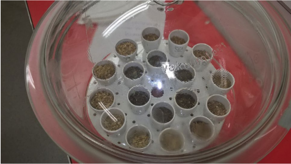
KUVA 9. Hevosenlantanäytteiden esikäsitteily (SFS-EN 14774-3) tuhkapitoisuuden (SFS-EN 14775) määrittämiseksi (kuva Riikka Tanskanen 2016).
