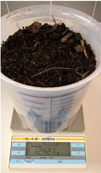
KUVA 2. Hevosenlantanäytteen irtotiheyden määrittäminen standardia SFS-EN 15103 mukaisesti (kuva Riikka Tanskanen 2016).
