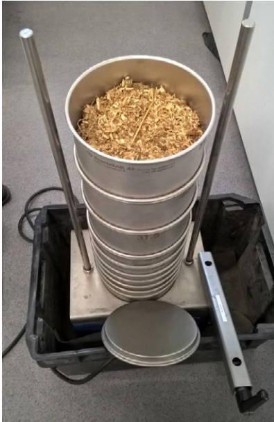
KUVA 6. Palakokojakauman määrittäminen täriseulalla (SFS-EN 15149-2 mukaisesti) (kuva Riikka Tanskanen 2016).
