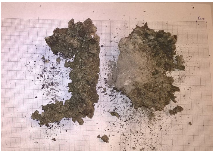
KUVA 13. Hevosenlantapelletin polttokokeen jälkeen pellettikattilan palopäästä poistettua sulanutta tuhkaa (kuva Riikka Tanskanen 2016).
