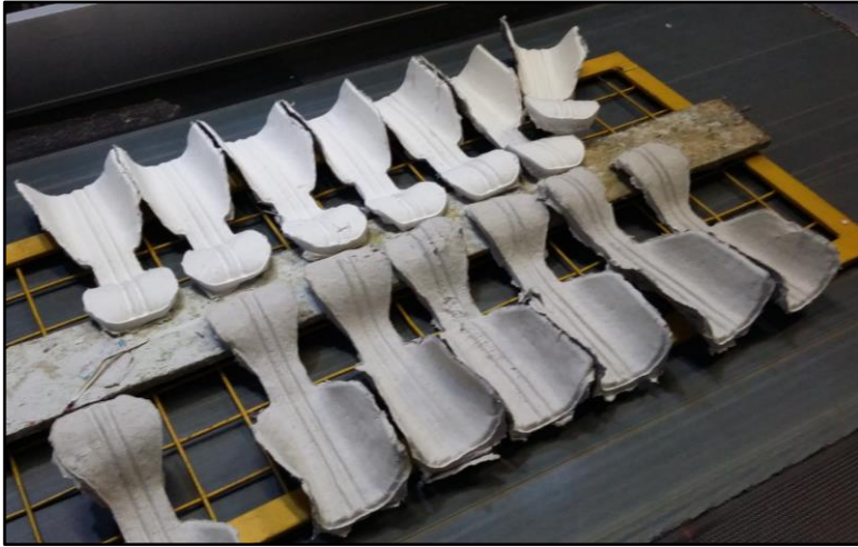
KUVA 22. Protolastat kuivatusuunin jälkeen, etupäät laudalla tuettuina
