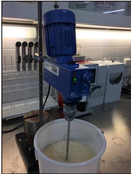
KUVA 8. Massaa sekoitetaan lisäaineiden lisäämisen aikana
