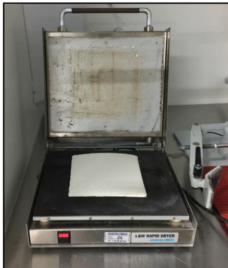
KUVA 10. Valmis arkki levykuivaimessa
