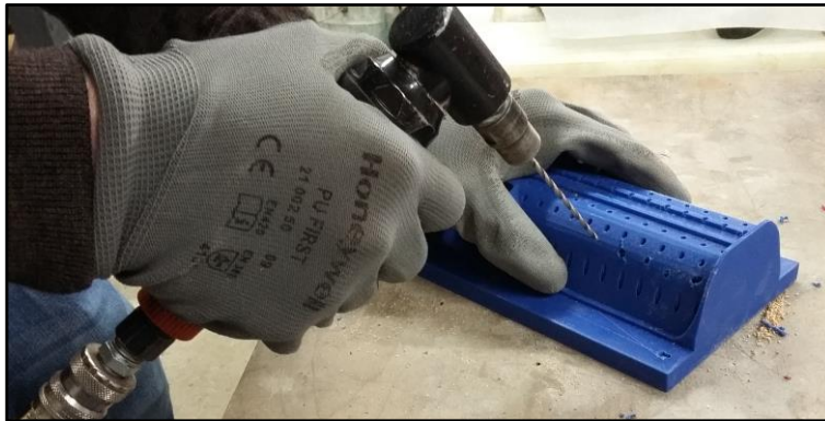
KUVA 17. Lisäreikien poraus paineilmaporalla
