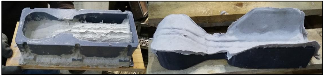
KUVA 20. Lasta muotissa (vas.) ja irrotettuna muotin vastakappaleen päällä (oik.)
