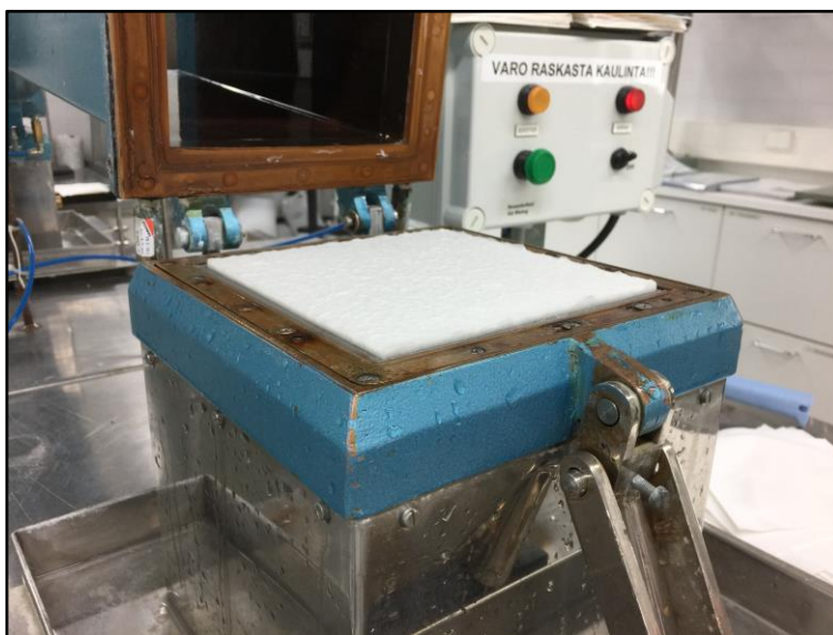
KUVA 9. Käsiarkkimuotti, jossa viiran päällä juuri valmistunut arkki
