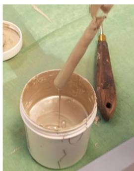
KUVIO 35. Painomusteiden varastoinnin jälkeinen sekoitus sekä laadun tarkastus ennen varsinaisia painoja. Vasemmalta oikealle hopea/hopeakloridi muste, grafiittimuste ja eristemuste.
