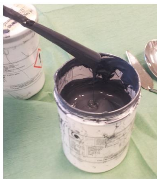
KUVIO 35. Painomusteiden varastoinnin jälkeinen sekoitus sekä laadun tarkastus ennen varsinaisia painoja. Vasemmalta oikealle hopea/hopeakloridi muste, grafiittimuste ja eristemuste.
