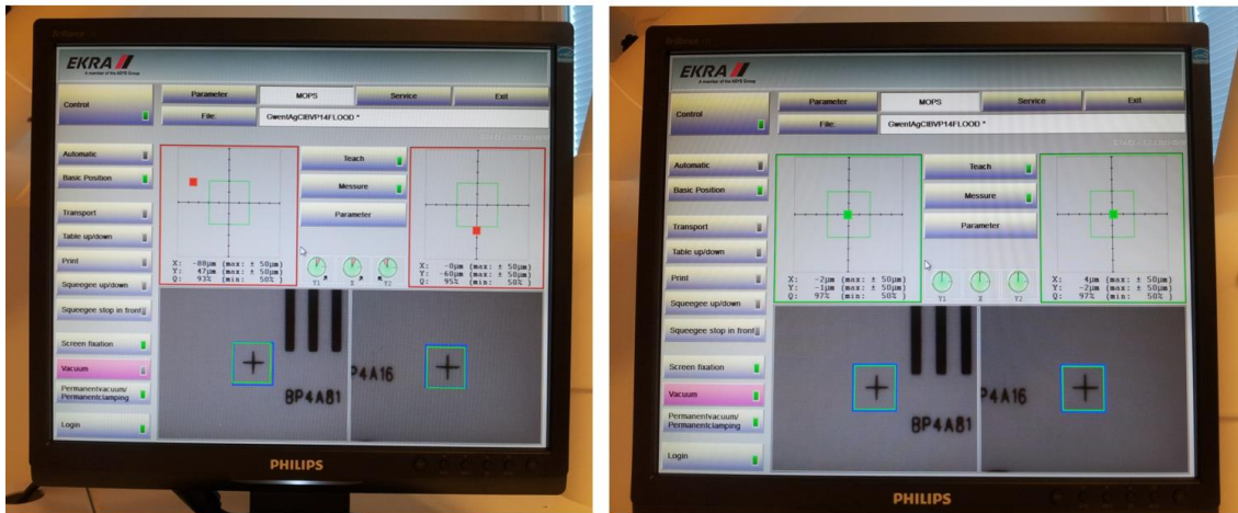
KUVIO 41. Ekra E2 käyttöliittymän manuaalisen optisen kohdistuksen periaate
