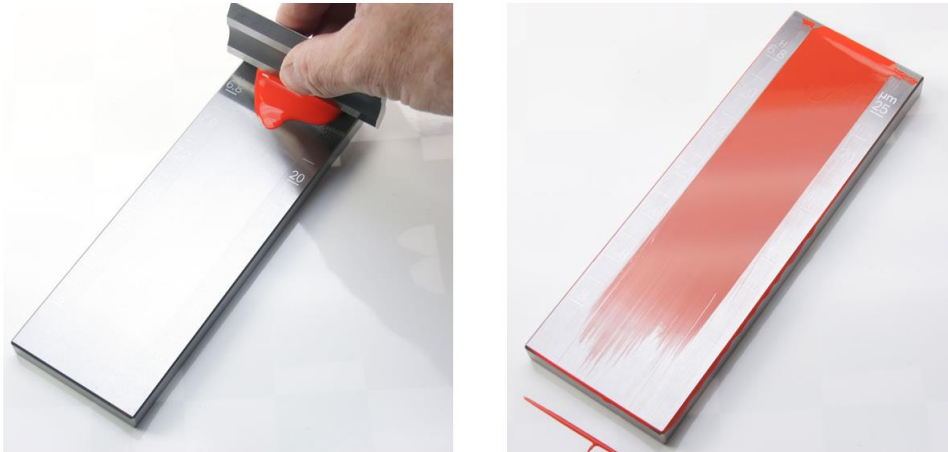
KUVIO 23. Grindometrin toimintaperiaate (TQC 2016)
