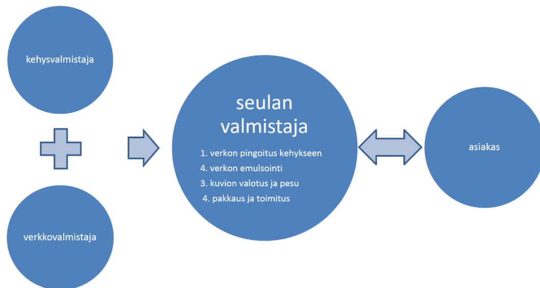
KUVIO 13. Painoseulan valmistusvaiheita painoseulan tilaajan näkökulmasta
