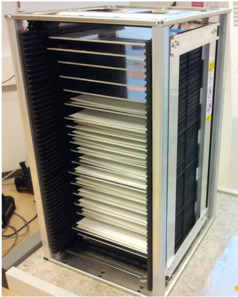
KUVIO 34. Painoprosessissa tarvittavat painoarkit saatiin kätevästi pieneen tilaan käyttämällä kuvan mukaista piirilevykehikkoa
