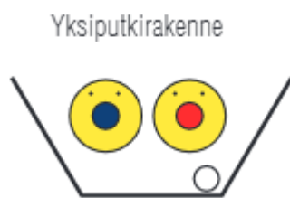
KUVA 2. Kaukolämpöjohdon periaatekuva, yksiputkirakenne (Logstor 2015)
