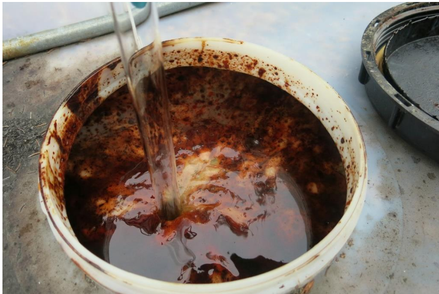
Kuva 11. Näytteenottoa lasisella putkinoutimella muovisessa säiliössä olevasta, pak- susta nesteestä ympäristörikospaikalla (kuva: Niina Viitala).
