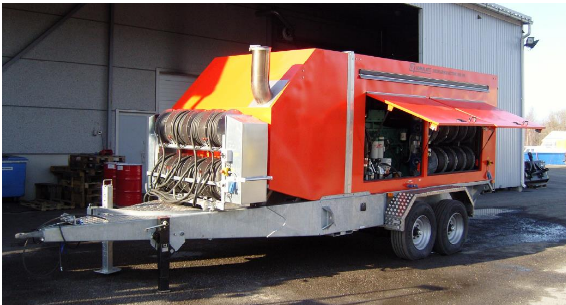
KUVA 4. 814 kVA varavoimakone (Voimalaitos Service Oya)
