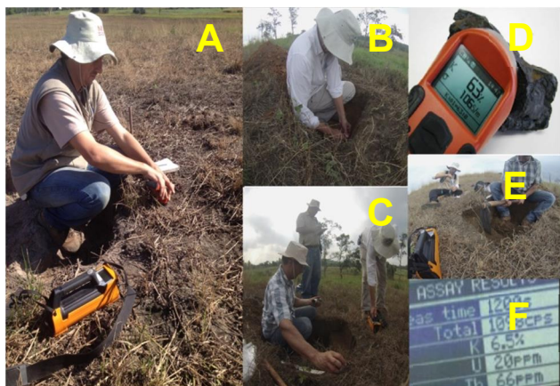
Figura 2. (a) Pesquisador realizando leituras em superfície com os sensores KT-10 S/C e RS-230 BGO; (b) Pesquisador medindo em subsuperfície com o sensor KT-10 S/C; (c, e) Pesquisador preparando minitrincheira para coleta de amostras; (d) Sensor KT-10 S/C em detalhe; (f) Painel do sensor RS-230 BGO.
