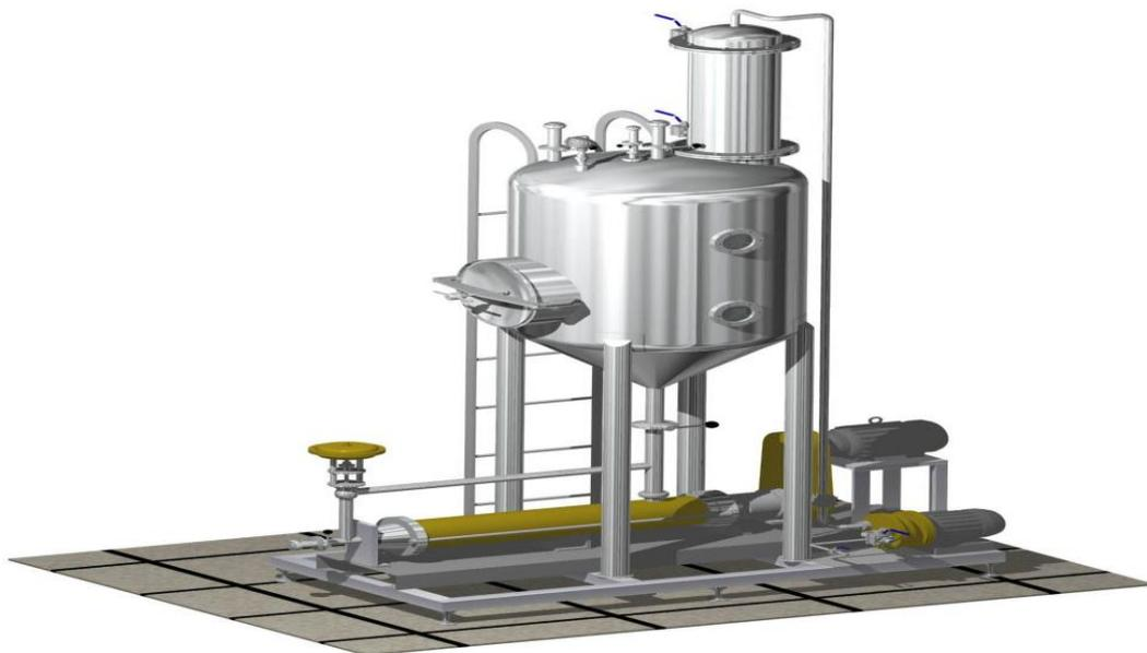
**Figura 7.** Exemplo de homogeneizador - desaerador para néctar de frutas.
