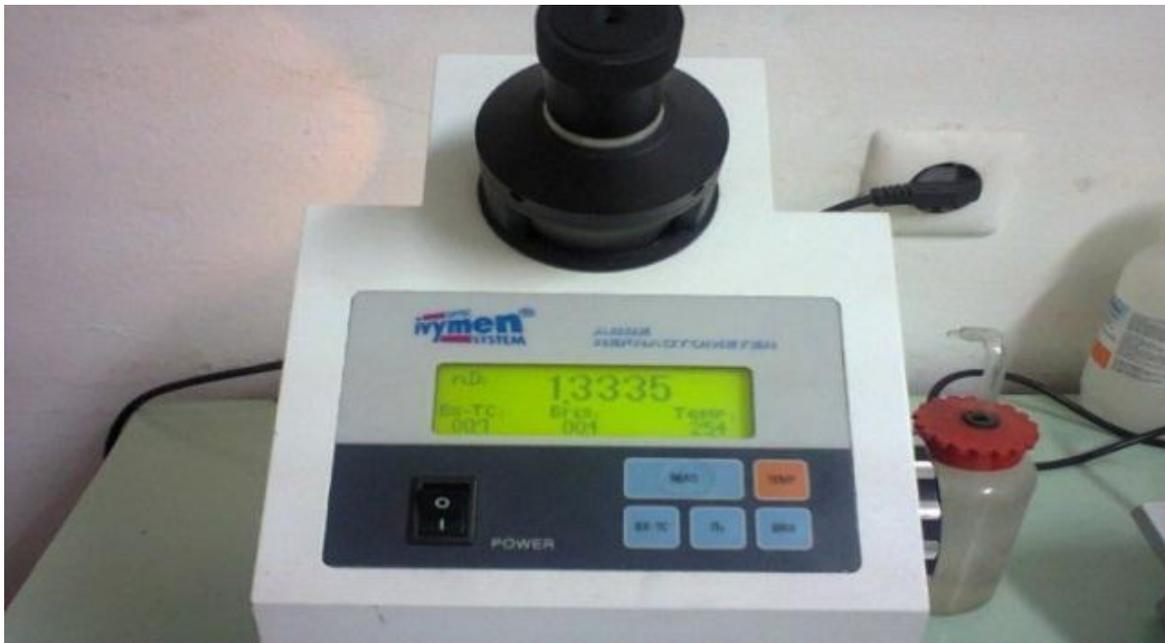
Figura 19. Refratômetro usado na leitura do Brix.
