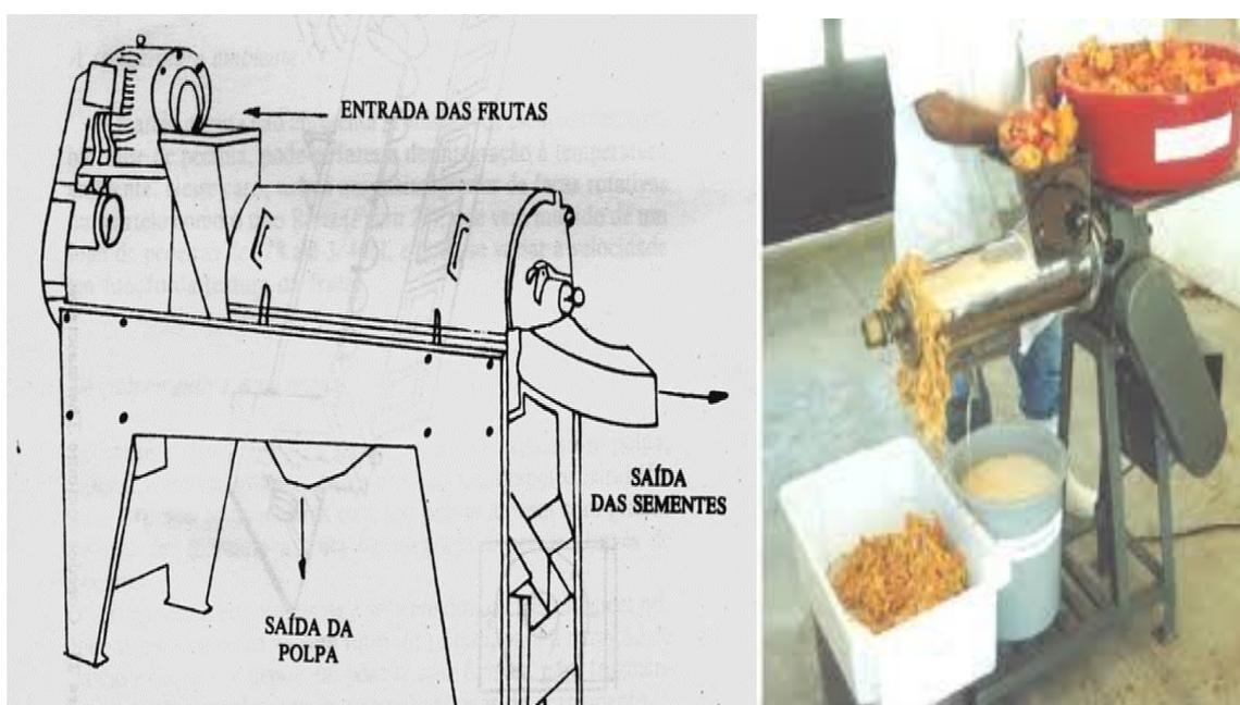
Figura 4. Exemplo de despulpadeira de aço inoxidável.
