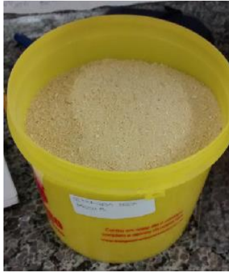
Figura 1. Serragem de Pinus taeda peneirada em peneira granulométrica Mesh 8.
