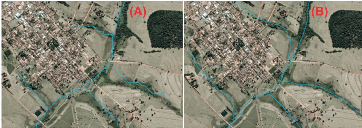
Figura 2. Exemplo da rede hidrográfica do IBGE (A) e da hidrografia editada (B) com base nas ortofotos da Emplasa.
