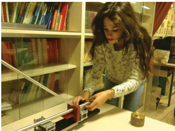
FIGURA 1. Montaje del sismómetro horizontal SEP.
