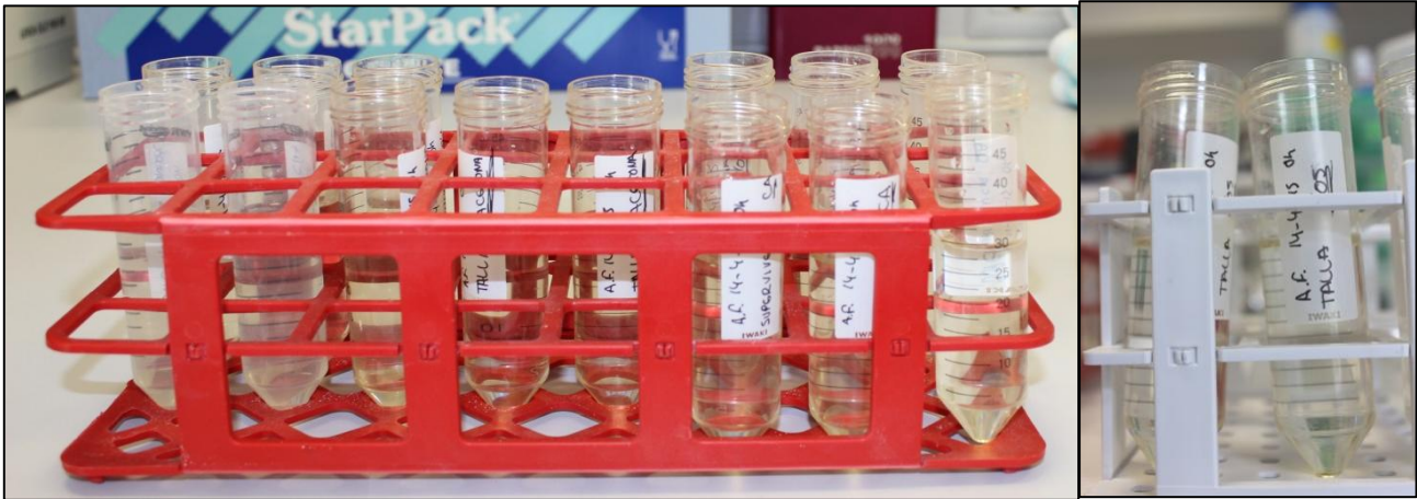
Figura 4. Sistema para el seguimiento de supervivencia y crecimiento de A. franciscana en diferentes tratamientos mediante tubos de plástico tipo Corning.
