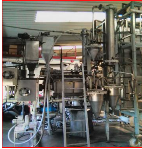
Figura 21. Planta piloto equipada con un reactor de tornillo sin fin utilizada para llevar a cabo el proceso de pirólisis de biomasa y de NFU.
