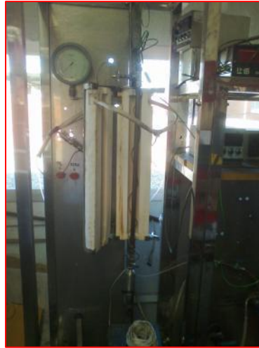
Figura 19. Instalación de lecho fijo diseñada para llevar a cabo el proceso de pirólisis de biomasa y NFU
