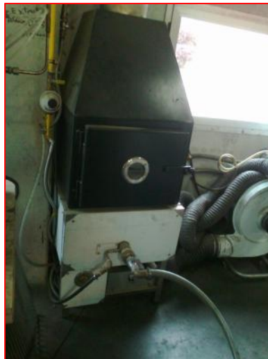
Figura 28. Quemador de llama auxiliar situado a la salida de la planta piloto utilizada para llevar a cabo el proceso de pirólisis de biomasa y NFU.
