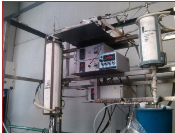
Figura 31. Instalación equipada con un reactor de lecho fijo utilizada para llevar a cabo el proceso de craqueo catalítico de los vapores del bioaceite .
