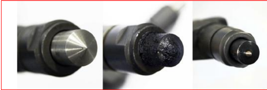
Figura 10. Representación de los problemas asociados con la inyección de bioaceites en motores alternativos. Inyector nuevo (Izquierda). Inyector usado tras 10 h con bioaceite (centro). Inyector usado tras 10 h con diésel (derecha) [72].
