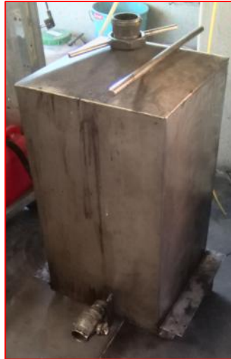
Figura 24. Depósito de recogida de sólidos de la planta piloto utilizada para llevar a cabo el proceso de pirólisis de biomasa y NFU.
