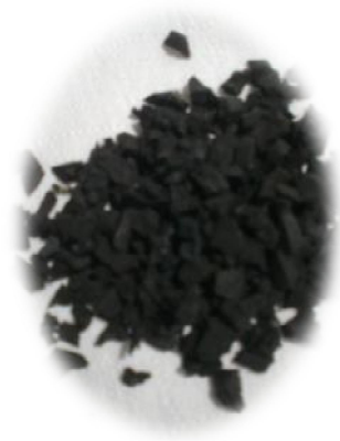
Figura 17. NFU suministrado por AMSA S.A tras la separación del entramado metálico y tras haber sido sometido a un proceso de trituración.
