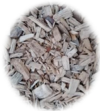
Figura 16. Biomasa-astilla de pino (AFPURNA, S.L) antes de ser sometida al proceso de molienda y tamizado
