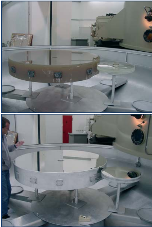
Espejos primario y secundario antes y después del aluminizado.
