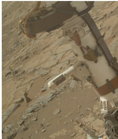
Fotografías de los dos "booms" de REMS tomadas por Curiosity en sol 526. Debajo: estado de los fotodiodos en sol 526. Se puede apreciar el efecto de los imanes en la prevención contra la deposición de polvo. Fuente: NASA/JPL-Caltech/MSSS.
