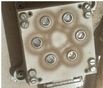
Fotografías de los dos "booms" de REMS tomadas por Curiosity en sol 526. Debajo: estado de los fotodiodos en sol 526. Se puede apreciar el efecto de los imanes en la prevención contra la deposición de polvo. Fuente: NASA/JPL-Caltech/MSSS.
