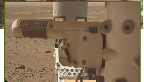
Fotografías de los dos "booms" de REMS tomadas por Curiosity en sol 526. Debajo: estado de los fotodiodos en sol 526. Se puede apreciar el efecto de los imanes en la prevención contra la deposición de polvo. Fuente: NASA/JPL-Caltech/MSSS.
