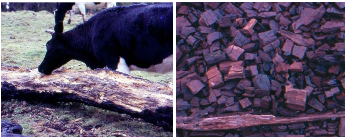
Figura 5. Patrones de degradación de la madera por los basidiomicetes. A la izquierda, patrón de degradación por un hongo de la podredumbre blanca que elimina la lignina dejando accesibles la celulosa, de color blanquecino, que excepcionalmente puede llegar a ser consumida por el ganado. A la derecha, patrón de degradación por un hongo de la podredumbre parda, donde los polisacáridos son consumidos y la lignina permanece in situ como un residuo polimérico de color parduzco. Tomado de Martínez et al. (Martínez et al., 2011).
