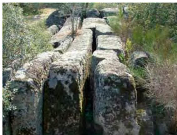
Fig. 21. Restos de extracción con dimensiones preparadas para la transformación en sillares.
