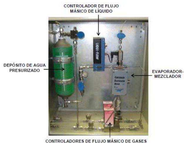
Figura 3.6 Detalle del generador de vapor de agua utilizado en la termobalanza.
