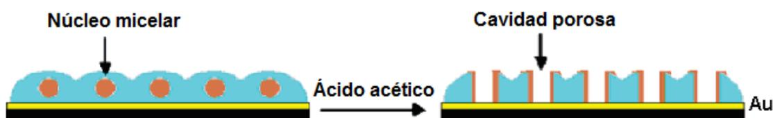
*Figura 26. Obtención de películas porosas por reconstrucción con ácido acético.*
