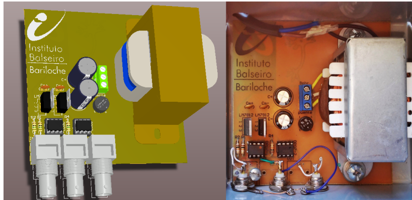
Figura 8.3: Modelo 3D del circuito impreso del sumador (izquierda) y versión final del sumador (derecha).
