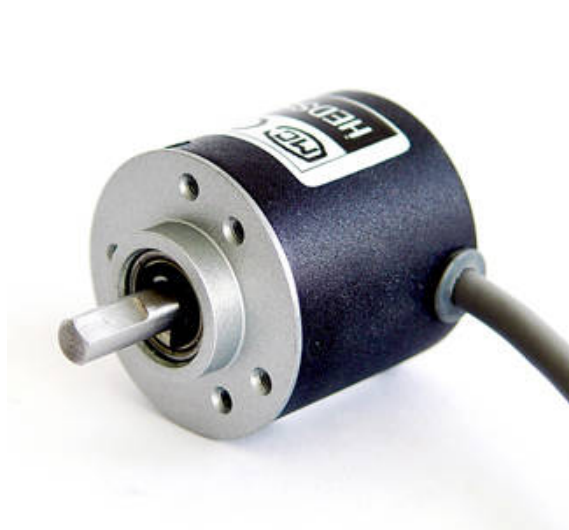
(a) Encoder HEDSS ISC3806 de 1000 pasos por vuelta. El mismo, si se programa de acuerdo al paso de flancos, puede obtenerse una resolución de 4000 pasos por vuelta.
