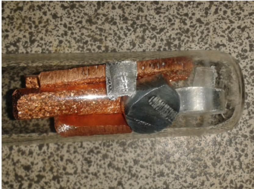
Figura 2.1: metales puros (Cu, Zn y Al) encapsulados en la ampolla.
