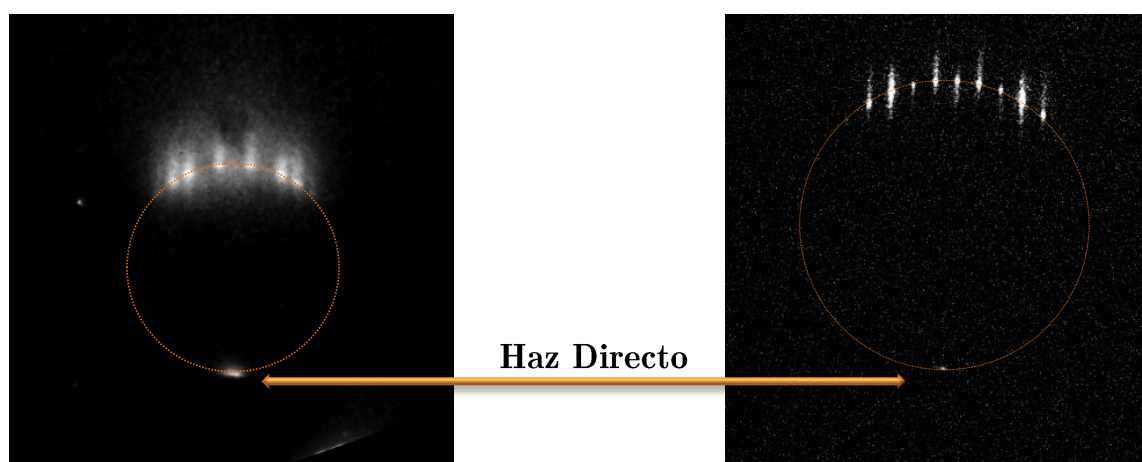
Figura 6.3: Difracción de Átomos de He en LiF a 0.5 keV. Medición tomada en el Laboratorio de física de Superficies de Bariloche (izquierda). Medición tomada en París en el Laboratorio de Philippe Roncin.
