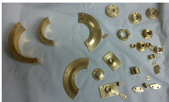
Figura C.3: Electrodo que componen el monocromador de electrones con baño de oro.
