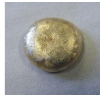
Figura 2.5. Aleación policristalina de Cu-Zn-Al pulida químicamente, con un diámetro de \sim 2,5\text{cm} . A la izquierda se muestra encapsulada en punta con gas argón, y su peso en gramos. A la derecha en detalle, donde se observan los bordes de grano.
