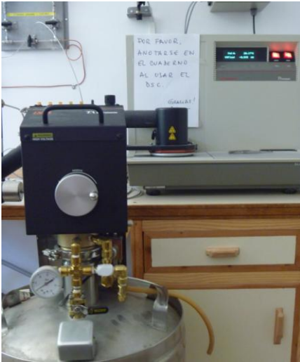
Figura 2.10. Equipo de calorimetría utilizado. A la derecha se ve la muestra (M) y la referencia de cobre (R) del mismo espesor. Es notable la diferencia de forma entre ambas; la martensita monovariante tiene forma elíptica, que refleja macroscópicamente el cambio de fase estructural. Una vez retransformada, recupera su forma circular.
