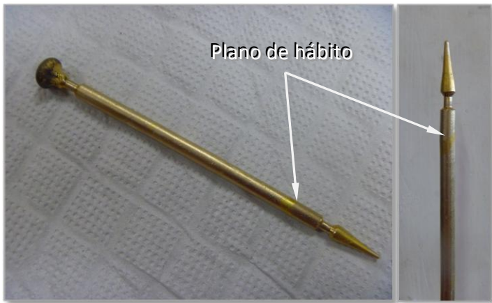
Figura 2.8. Clavo transformado por tensión. Se observa una deformación macroscópica del sólido y un cambio de color del clavo. Cerca de la punta, y en detalle a la derecha se ve una interfase austenita-martensita, distinguida por la diferencia de color entre ambos lados.
