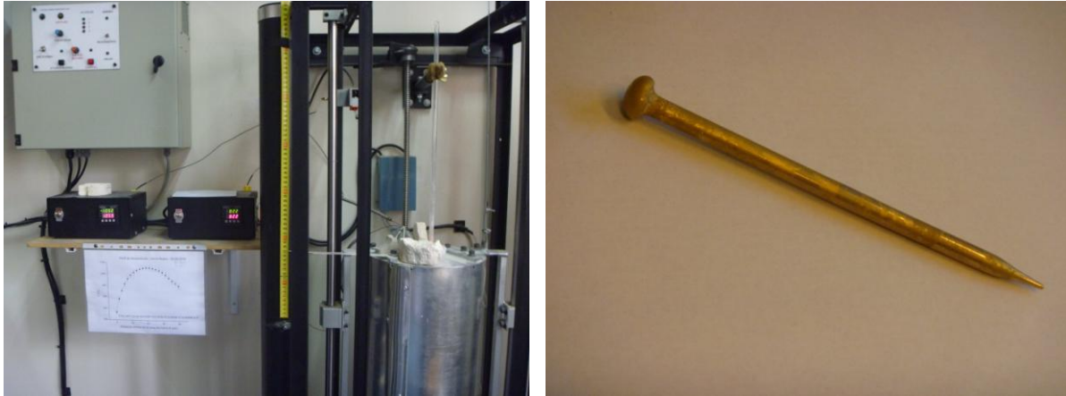
Figura 2.6. Derecha: horno resistivo utilizado para la fundición de los metales de la aleación Cu-Zn-Al. Para solidificar el monocristal desde la punta, la cápsula con el metal fundido se mantiene fija, y el horno, con un gradiente vertical de temperatura, se mueve lentamente hacia arriba. Izquierda: clavo policristalino obtenido. Se observan algunos bordes de grano, pero áreas de monocristal suficientemente amplias. Las dimensiones del clavo están dadas por: diámetro d=6 mm, largo L=13 cm y masa m=23,630 g.
