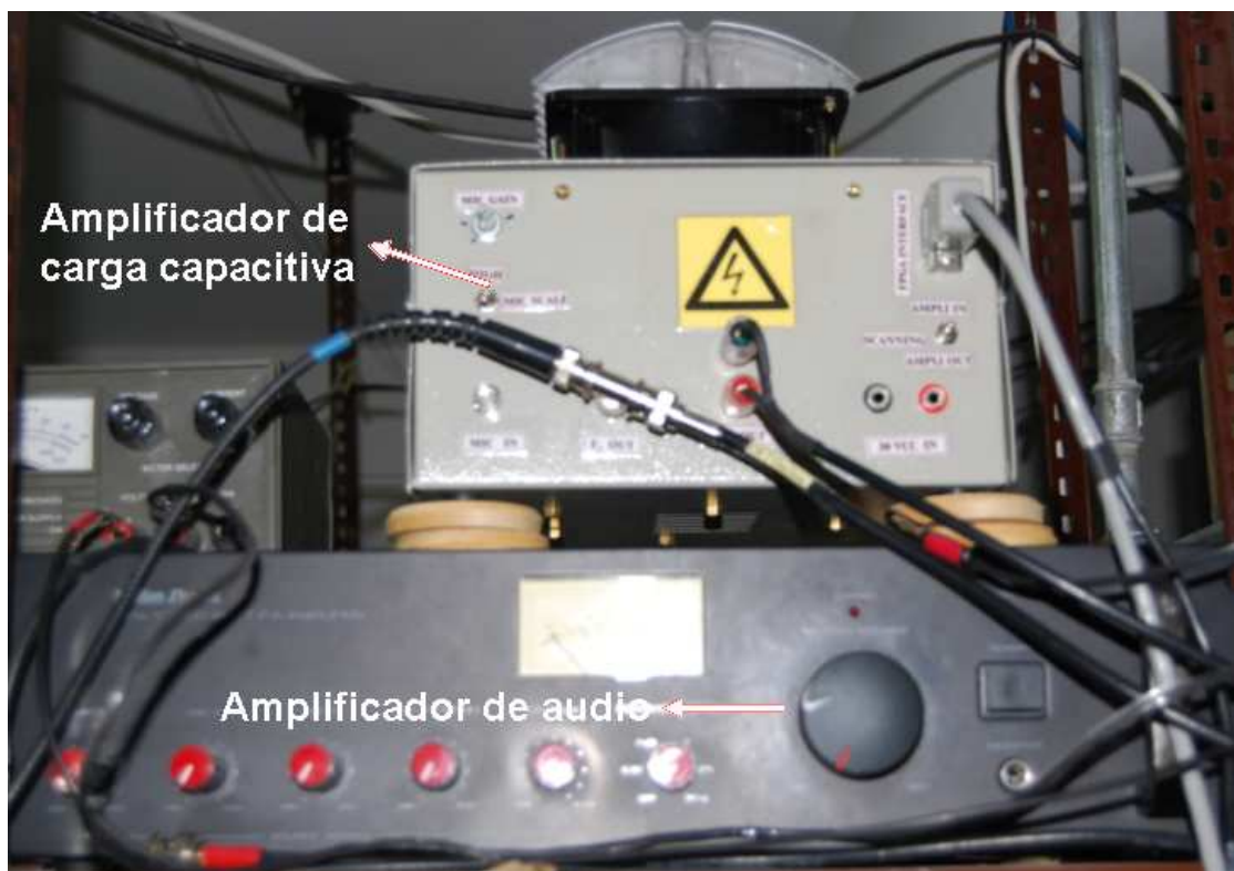
Figura 7. Amplificador de carga capacitiva y amplificador de audio, correspondientes a la primera y segunda etapa de amplificación de la señal de excitación de los PZT, respectivamente.
