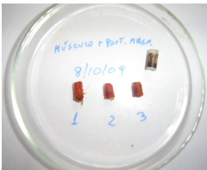
Figura 5.1: Muestras de carne para determinación de la cantidad de material magnético a través de la medición de magnetización versus campo. La muestra 1 no contiene material magnético, mientras que la 2 y la 3 contienen nanopartículas extraídas de soluciones con distintas concentraciones. Dentro del portamuestras, la muestra del líquido con mayor concentración. No se muestra la correspondiente al líquido con menor concentración.
