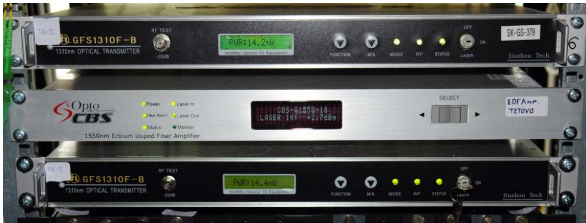
Слика 36. Оптички предаватели (во средината е оптички EDFA засилувач) Figure 36. Fiber optic transmitters (in the middle is EDFA fiber optic amplifier)
