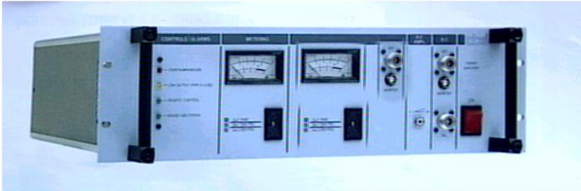
Слика 6. Висококвалитетен професионален модулатор за CATV
