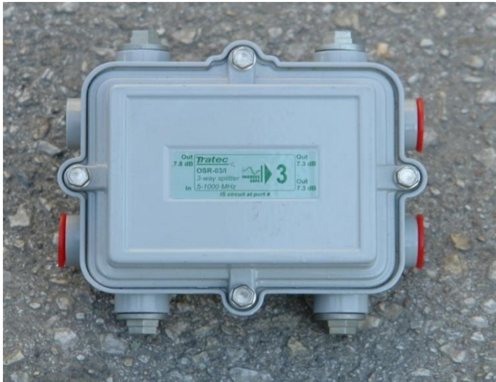
Слика 60. Надворешен „AC-pass“ сплитер (овозможува премин на струја) Figure 60. Outdoor AC-pass splitter
