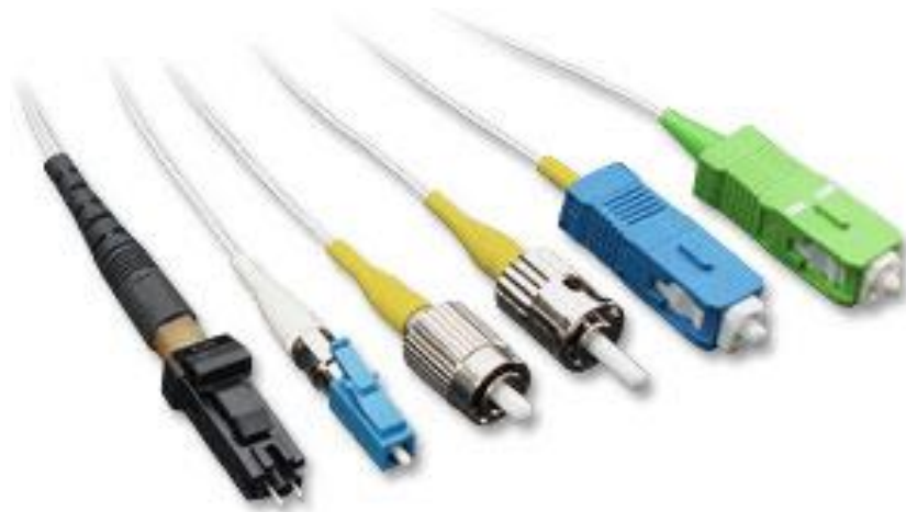
Слика 30. Разни типови на оптички конектори
