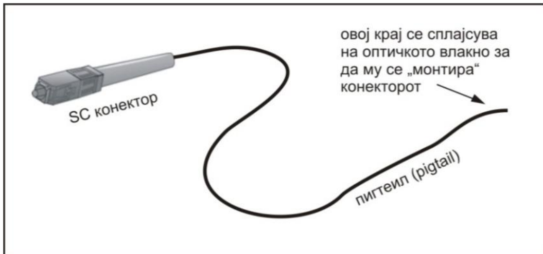
Слика 26. Конектор со „пигтејл“
