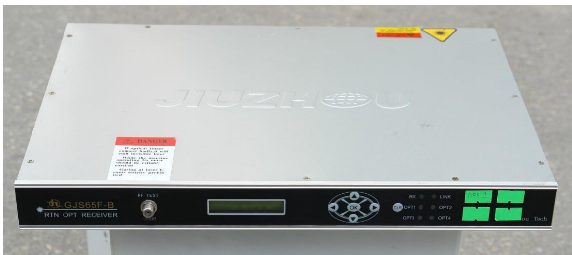
Слика 37. Оптички приемник за повратен пат (предна страна)
