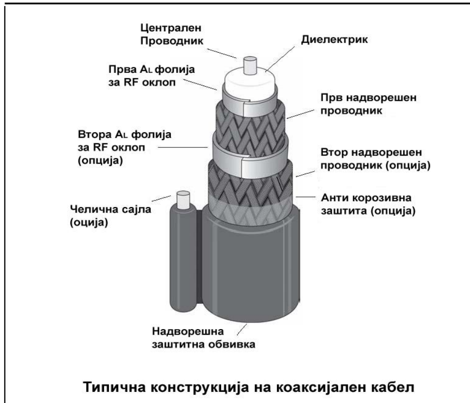
Слика 48. Коаксијален кабел
