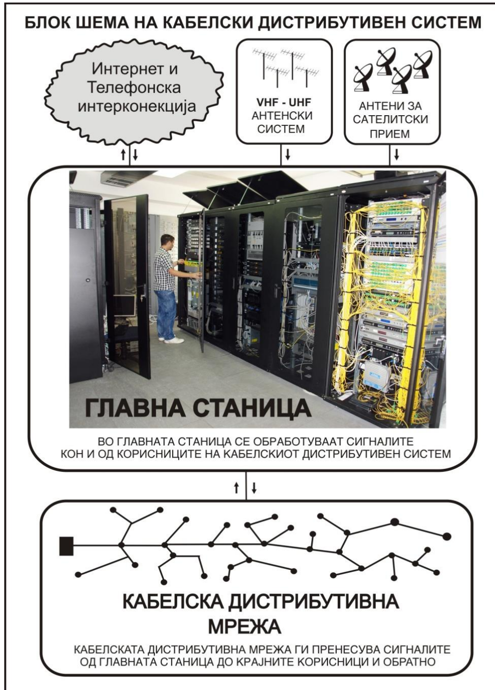
Слика 1. Блок шема на кабелски дистрибутивен систем
