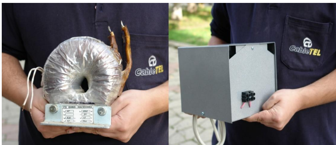
Слика 56. Трансформатор за напојување на засилувачите преку коакс. кабел Figure 56. Transformer for remote AC powering the amplifiers trough coax cable
