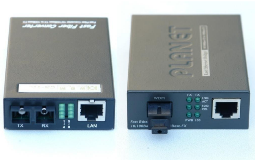
Слика 41. Медија конвертор со две (лево), и со едно оптички влакно (десно) Figure 41. Media convertor with 2 (on the left), and 1 optical fibre (on the right)
