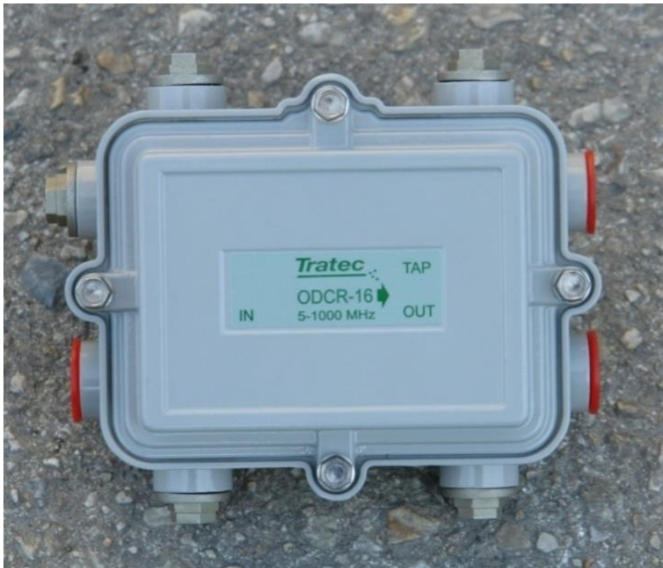
Слика 61. Надворешен „AC-pass“ тап (овозможува премин на струја) Figure 61. Outdoor AC-pass tap
