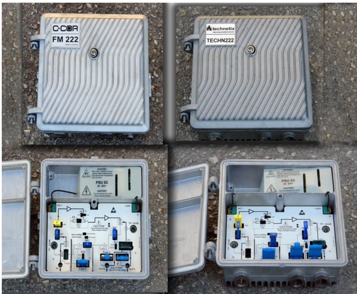
Слика 52. Двонасочни хибридни засилувачи за КДС
