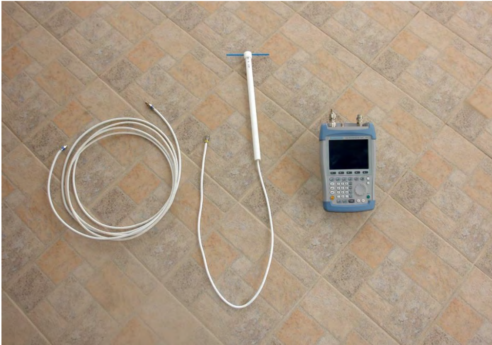
Слика 45. Антена број 3 - конструирана за мерење на електромагнетното зрачење во фреквенцискиот опсег од 850 до 1500 Mhz.
