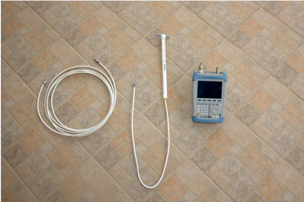
Слика 47. Антена број 4 - конструирана за мерење на електромагнетното зрачење во фреквенцискиот опсег од 1500 до 2000 Mhz.
