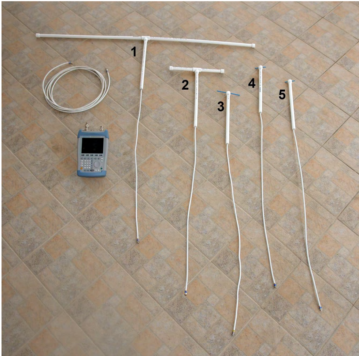
Слика 40. Изработени антени за мерење на електромагнетното зрачење Figure 40. Antennas constructed for electromagnetic radiation measurements
