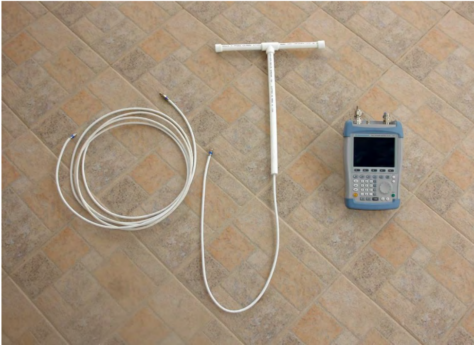
Слика 43. Антена број 2 - конструирана за мерење на електромагнетното зрачење во фреквенцискиот опсег од 350 до 850 Mhz.
