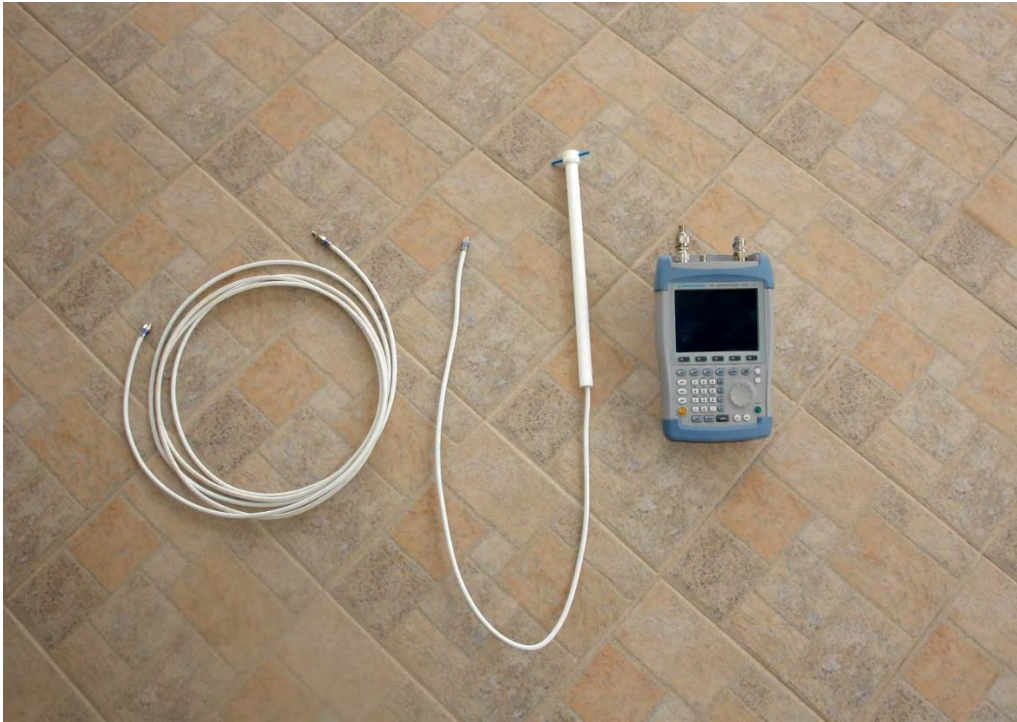
Слика 49. Антена број 5 - конструирана за мерење на електромагнетното зрачење во фреквенцискиот опсег од 2000 до 3000 Mhz.
