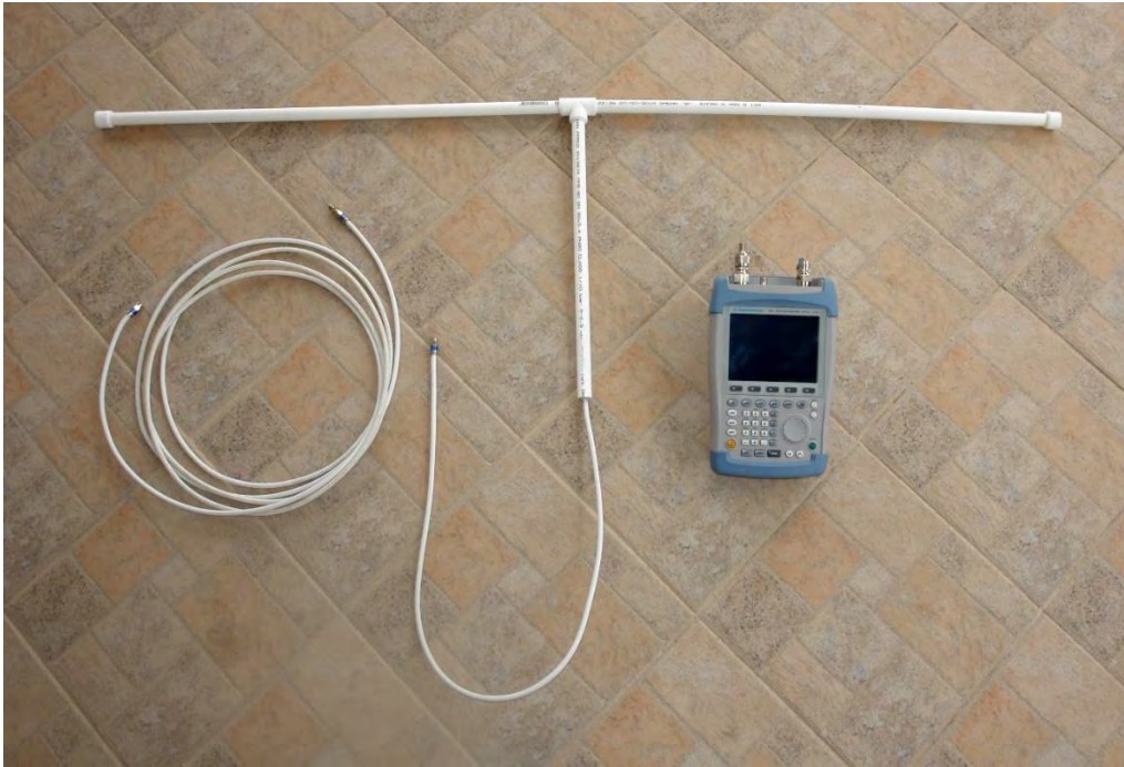
Слика 41. Антена број 1 - конструирана за мерење на електромагнетното зрачење во фреквенцискиот опсег од 30 до 350 Mhz.
