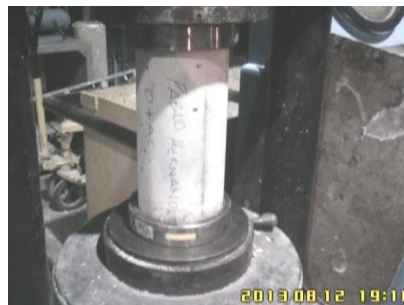
Figura 26. Ensayo de cilindros de mezcla obsidiana + arena caliza
