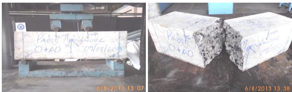
Figura 19. Ensayo a flexión en viga de concreto (O+AO)
