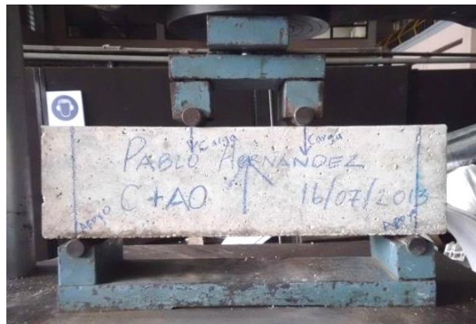
Figura 34. Ensayo a flexión en viga de concreto caliza + pirita
