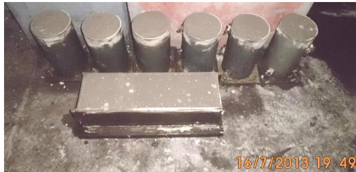
Figura 32. Especímenes para pruebas de compresión
