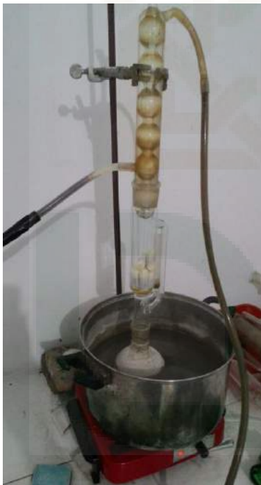
(i) Soxlet untuk menguji kadar lemak
