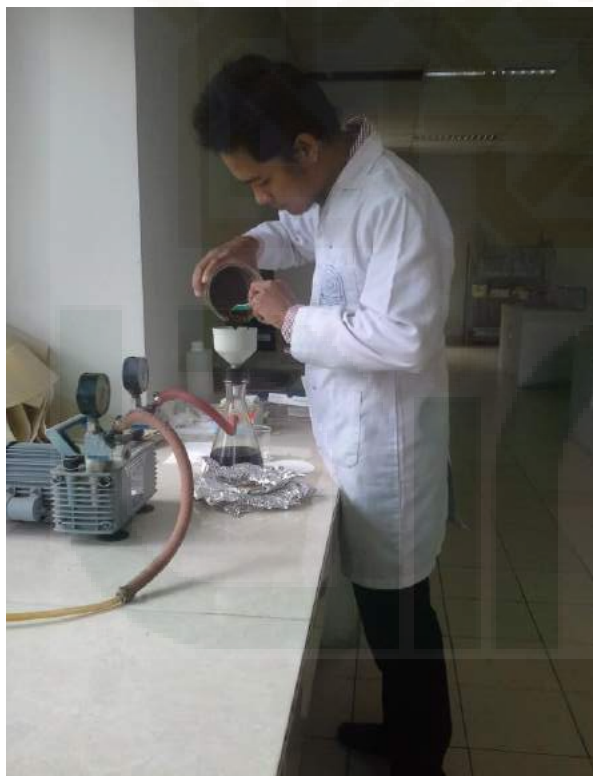
(a) Proses penyaringan dengan penyaring buchner
