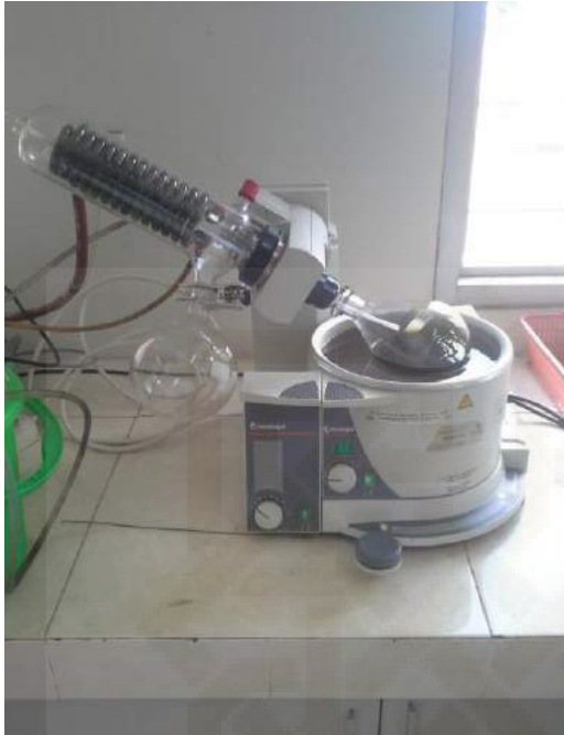
(b) Proses penguapan menggunakan rotary evaporator
