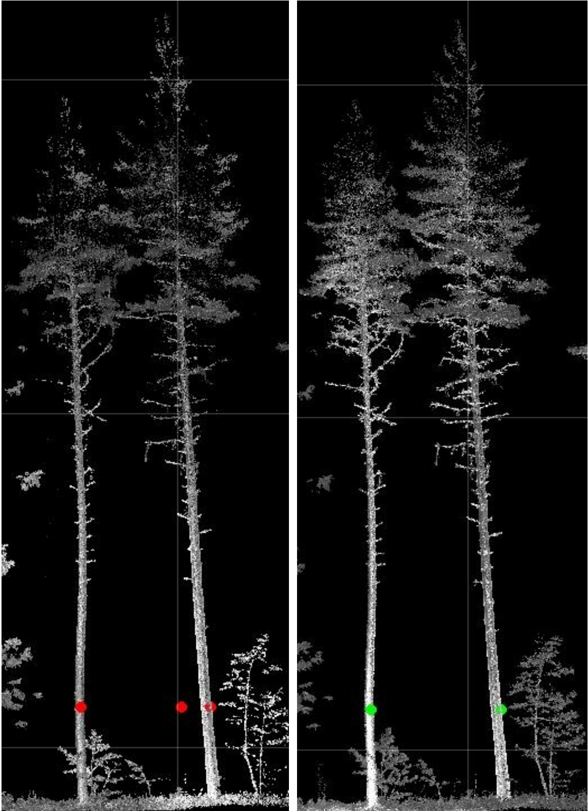
Kuva 16: Koeala 1048. Algoritmin löytämät puut punaisella ja vihreällä. Vasemmalla Trimblen aineisto ja oikealla Leican aineisto.
