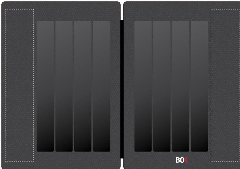
Kuva 44. bokin kansien leveät reunat ovat paineentunnistavia ja toimivat ergonomisina sivunvaihtopainikkeina (valkoisella katkoviivalla merkitty alue).
