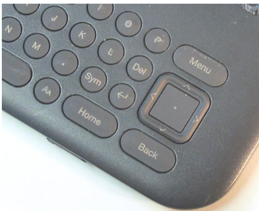
Kuva 14. Kindle 3:n monia toimintoja oli sijoitettu lähellä toisiaan sijaitseviin painikkeisiin. Kuvassa oikealla neliömäinen monitoimipainike ”5-way joystick”, joka aiheutti helposti virhepainalluksia. Qwerty-näppäimistön epästandardit näppäimet herättivät ihmetystä, esimerkiksi Sym ja Aa. Jälkimmäisellä säädettiin tekstin pistekokoa. Vain harva löysi tämän toiminnon käyttöönottestissä.
