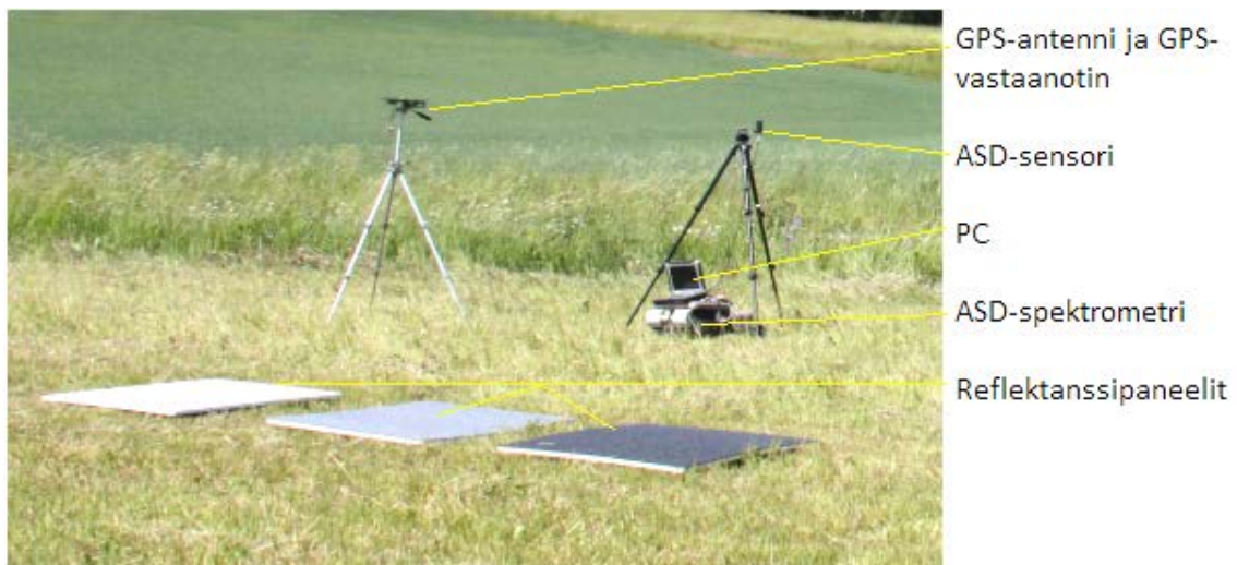
Kuva 4 Valkoinen (reflektanssi 0,5), harmaa (reflektanssi 0,1) ja musta (reflektanssi 0,03) reflektanssipaneeli, ASD-spektrometri, kosinikeräinoptiikka ja PC sekä GPS-antenni ja GPS-vastaanotin. GPS-vastaanottimen keräämän maa-aseman sijaintitietoa voidaan hyödyntää mm. kopterin keräämän GPS-datan jälkilaskennassa.
