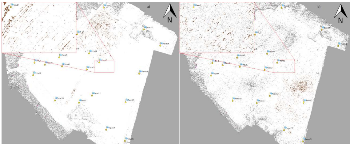
Kuva 17 Vihdin RGB- ja FPI-blokeille, joissa gps ja gcp tuki, toteutetun automaattisen maanpintaluokittelun tulokset, jossa maanpinnan pisteet ruskealla, kohinaiset pisteet pinkillä ja muut pisteet valkoisella. Kuvassa a) Vihdin RGB-blokki ja b) Vihdin FPI-blokki.
