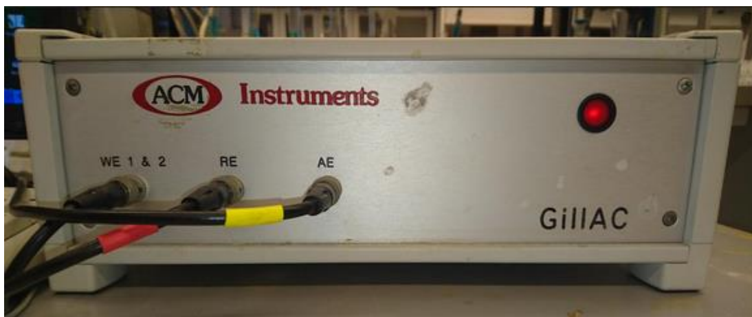
Kuva 63. RDE-mittauksissa käytetty potentiostaatti.
