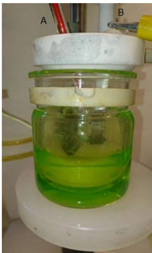
Kuva 62. RDE-mittauksissa käytetty koelaitteisto. A referenssielektrodi B pyörivä kultaelektrodi. Vastaelektrodina käytettiin platinal levyä. Reaktioastian virtasi lämpöhauteen vesi-glykoliliuos. Elektrodit oli kytketty potentiostaattiin.
