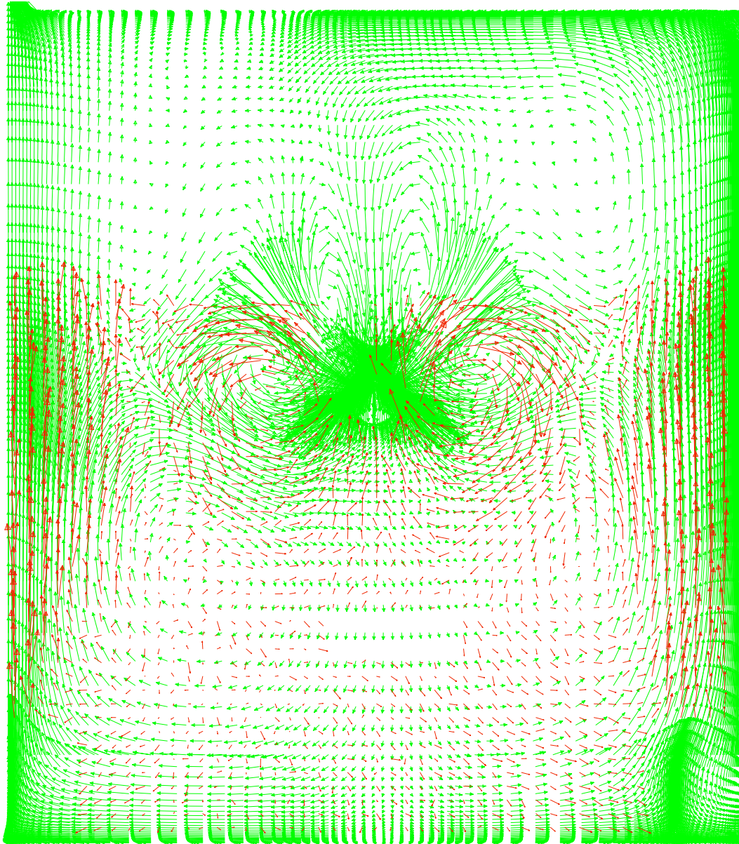
Kuva 9: Nopeusvektorit tasolla 1,2 m etuseinästä. Kuvassa punaisella mittaustulokset.
