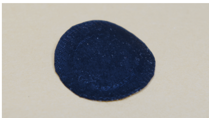
Kuva 21: PTFE/PP membraani on päällystetty kokonaan ohuella kerroksella tiivistyssilikonilla vedenpitävyyden parantamiseksi.
