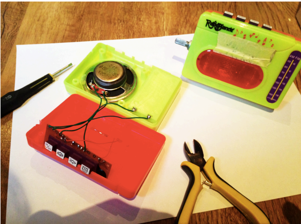
Kuvassa etualalla avattu rumpukone. Piirilevystä poistettu vastus. Taka-alalla bendattu ja jälleenkoottu rumukone, jossa säätövastus on asennettu rumpukoneen sivuun.
