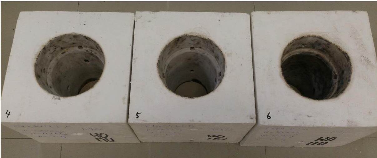
Kuva 8. Ekovillaa sisältäneissä muoteissa on nähtävissä pillkukkaita hiiltymisjälkiä.
