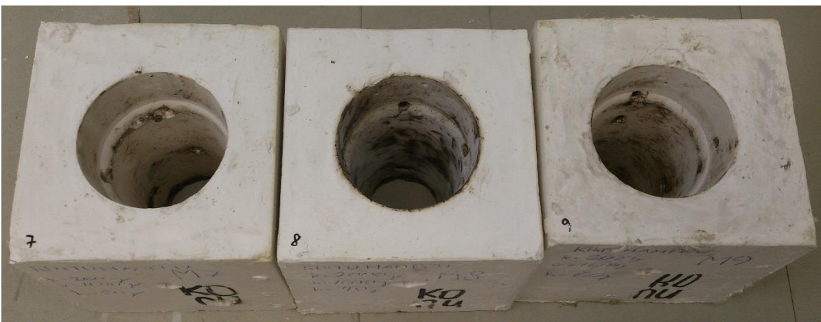
Kuva 9. Kuituhamppumuotit hiiltyivät vähiten käytetyistä muoteista.
