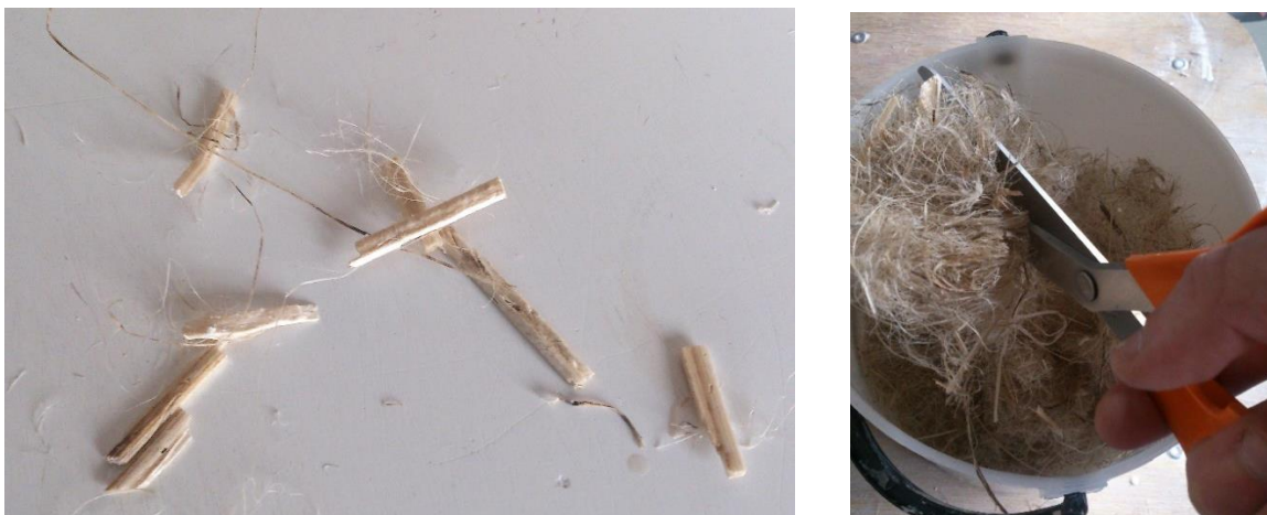
Kuva 4. Kuituhampun seasta ennen liottamista poistetut suuremmat kappaleet (vas.) ja oikealla hampun leikkaaminen lyhyemmiksi kuiduiksi.
