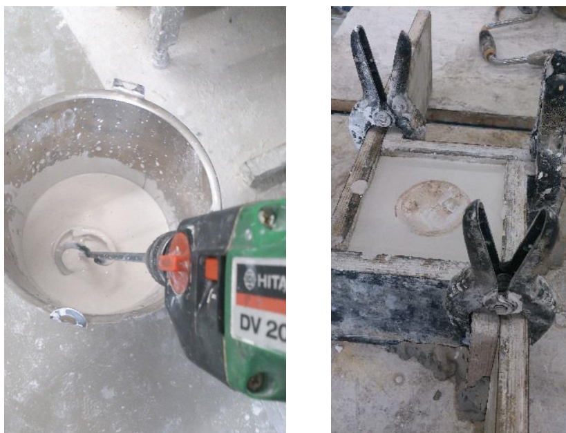
Kuva 5. Muottiseosmassa sekoitetaan porakoneella (vas.) ja puristimilla yhteen kiinnitettyjen valutukien väliin valettu kipsiseosmuotti.
