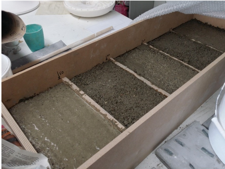
Kuva 17 Eri lasimurskasuhteilla valetut näytteet
