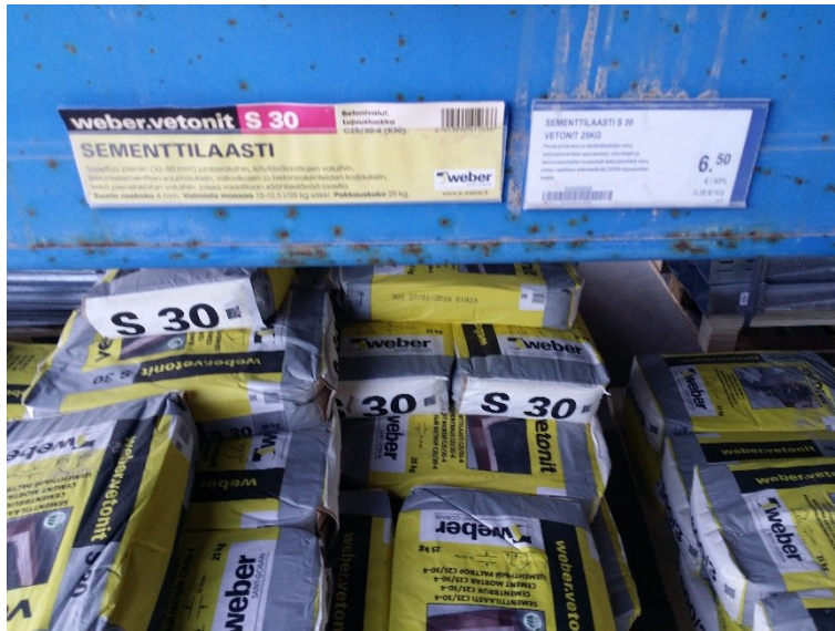
Kuva 4 Betonina käytettyä S30-sementtilaastia
