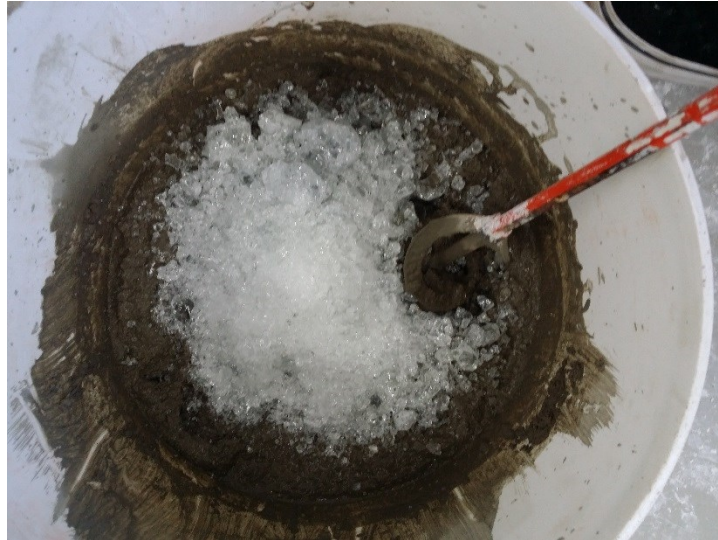
Kuva 10 Lasimurskan sekoittaminen betoniin
