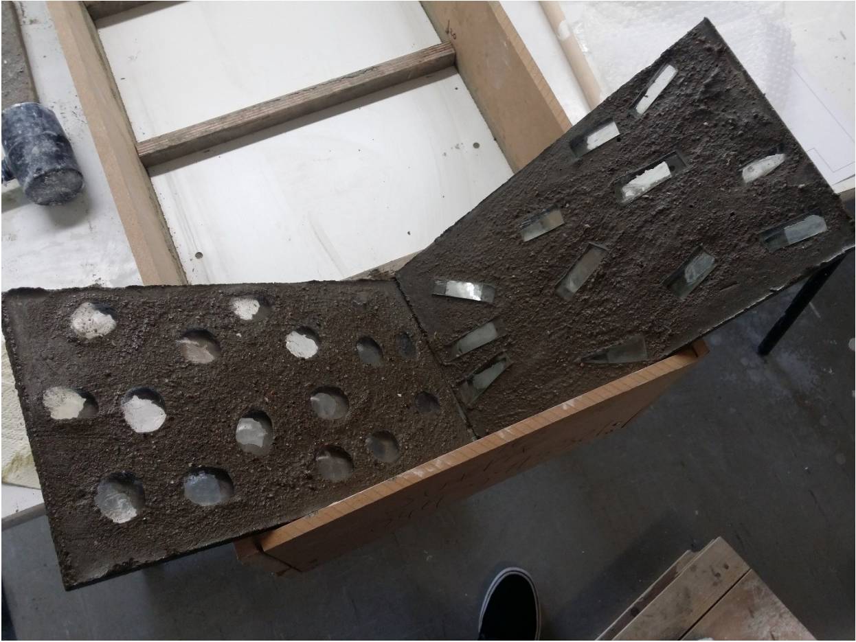
Kuva 14 Nugetit ja UV-liimatut lasinpalat 10 mm valussa
