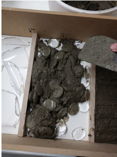
Kuva 9 Nugettien sekoittaminen betoniin
