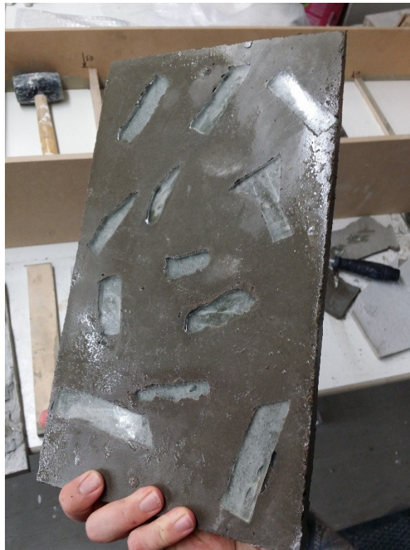
Kuva 11 Sementtiliimaa imeytyi kapillaarisesti kahden ikkunalasipalan väliin, jolloin valonläpäisevyys heikkeni
