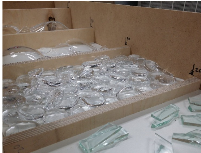
Kuva 8 Lähikuva betonin sekaan valettavista lasimateriaaleista
