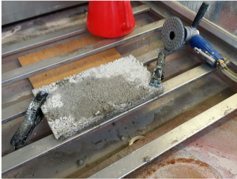
Kuva 15 Näytteitä käsiteltiin paineilmakäyttöisellä hiomakoneella
