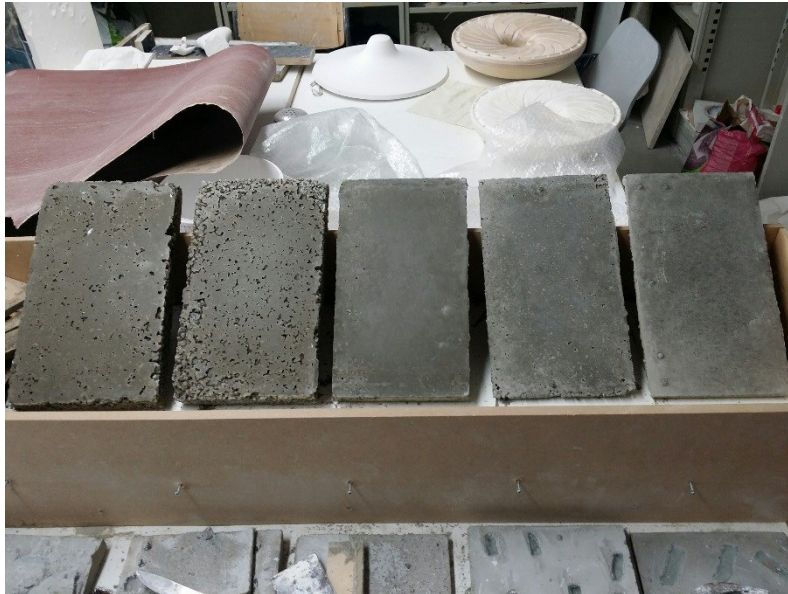
Kuva 19 Kovettuneet näytekalat lasimurskavaluista
