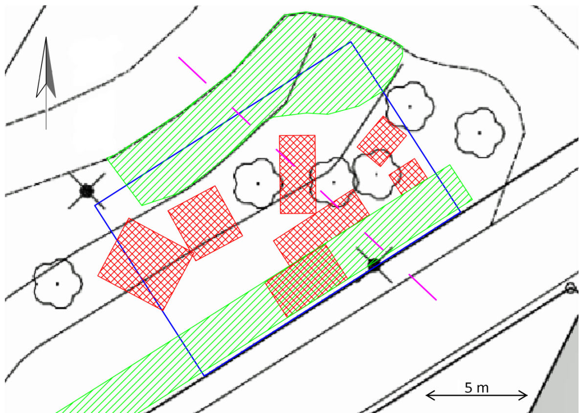
Kuva 7. 1 Suoritetut koekuoppatutkimukset Sorsavuorenraitilla 1.-2.10.2015. Kuvassa on esitetty punaisella koekuoppien likimääräiset sijainnit, sinisellä suunnitelmien mukainen tutkimuskentän alueen raja (15 x 10 m 2 ), katkoviivalla havaitun tuhkarakenteen vasen raja ja vihreällä alueella sijaitsevaa kasvillisuutta.
