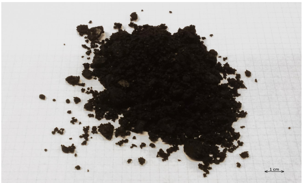
Kuva 7. 7 Tutkimuksessa käytetty kivihiilinäyte. Kuvan ruutupaperin yhden ruudun sivu on 5 mm.
