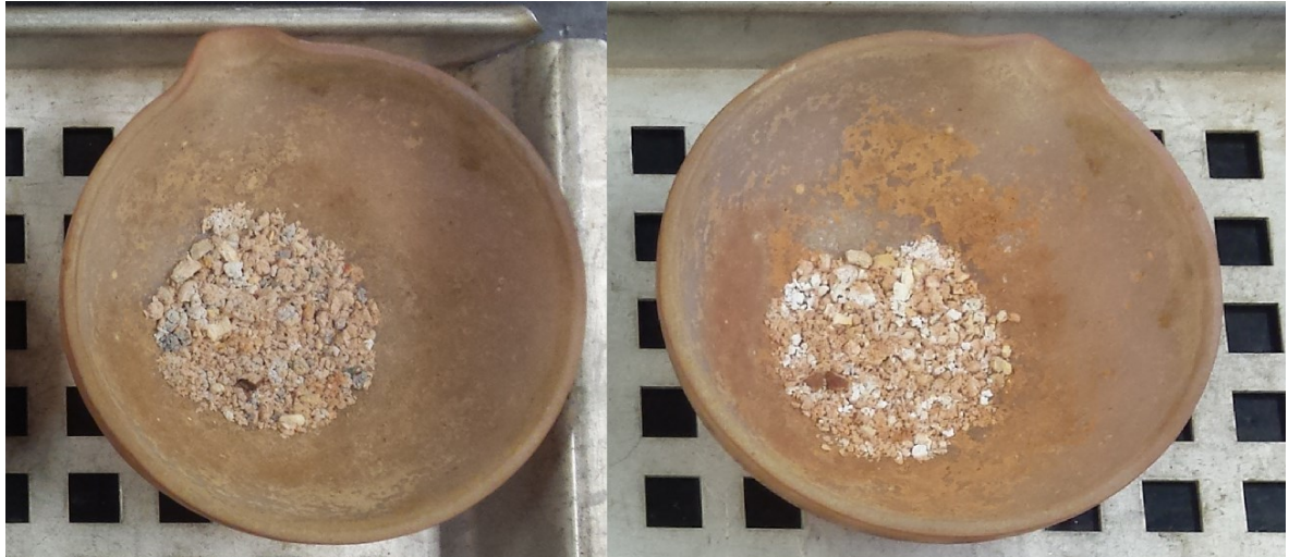
Kuva 7. 9 Kivihiilinäytteet 550 °C (vas.) ja 950 °C (oik.) lämpötilassa hehkutuksen jälkeen.
