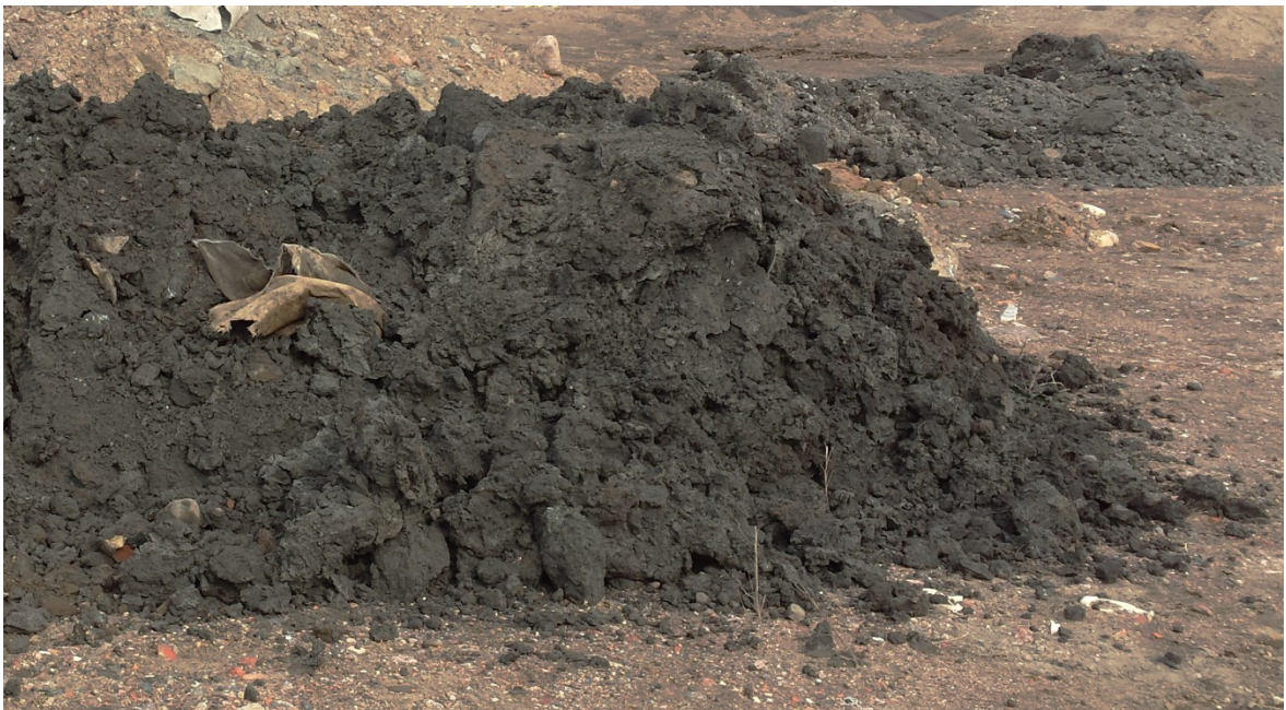
Kuva 4. 2 Jätkäsaari, allas 1. LT 75 kg/m 3 + RPT 75 kg/m 3 + Plussementti 50 kg/m 3 Auki kaivettua massastabiloitua sedimenttiä (kuva 27.3.2015).
