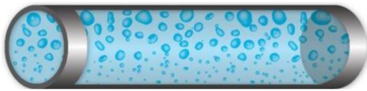
Kuva 3. Kuplavirtaus vaakasuorassa putkessa. [Bratland 2010]
