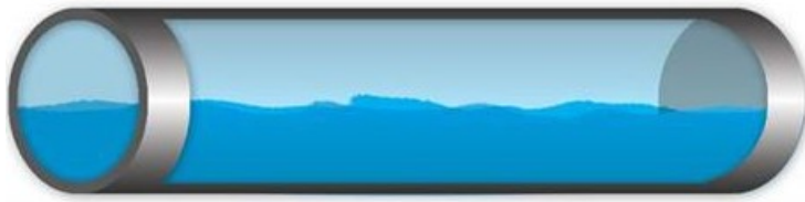
Kuva 5. Kerroksellinen aaltoileva virtaus. (stratified wavy flow) [Bratland, 2009]
