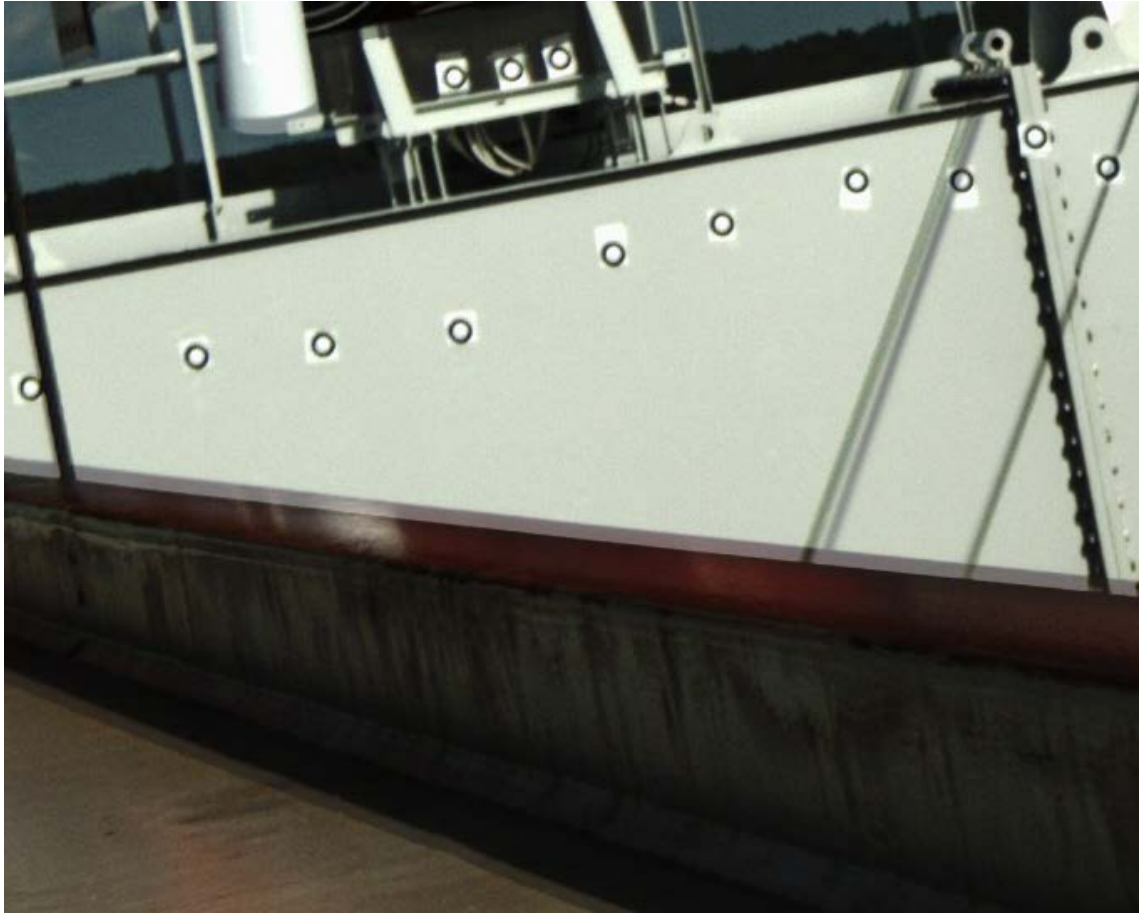
Kuva 21: Palkin taipuma kuormitettaessa
