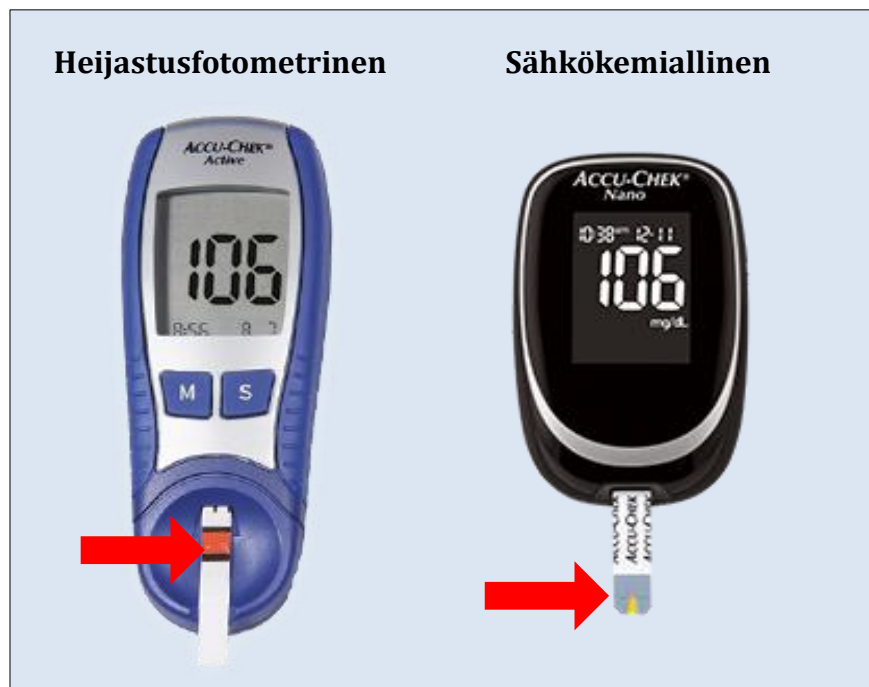
Kuva 8: Ero heijastusfotometrisen ja sähkökemiallisen verensokerin mittaliuskan asemoinnissa mittariin nähden. Muokattu lähteistä [66, 67].
