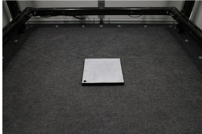
Kuva 26. Tason mittauksessa käytettävä mittakappale.
