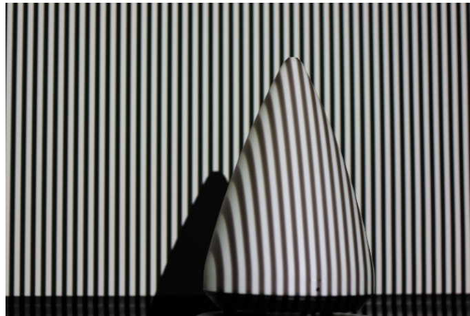
Kuva 1. Kartion muotoinen kohde valaistuna strukturoidulla valolla.
