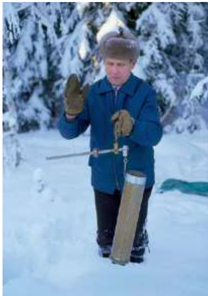
Kuva 2: Lumen tiheyden määrittäminen lumipuntarin avulla (kuva: Esko Kuusisto)
