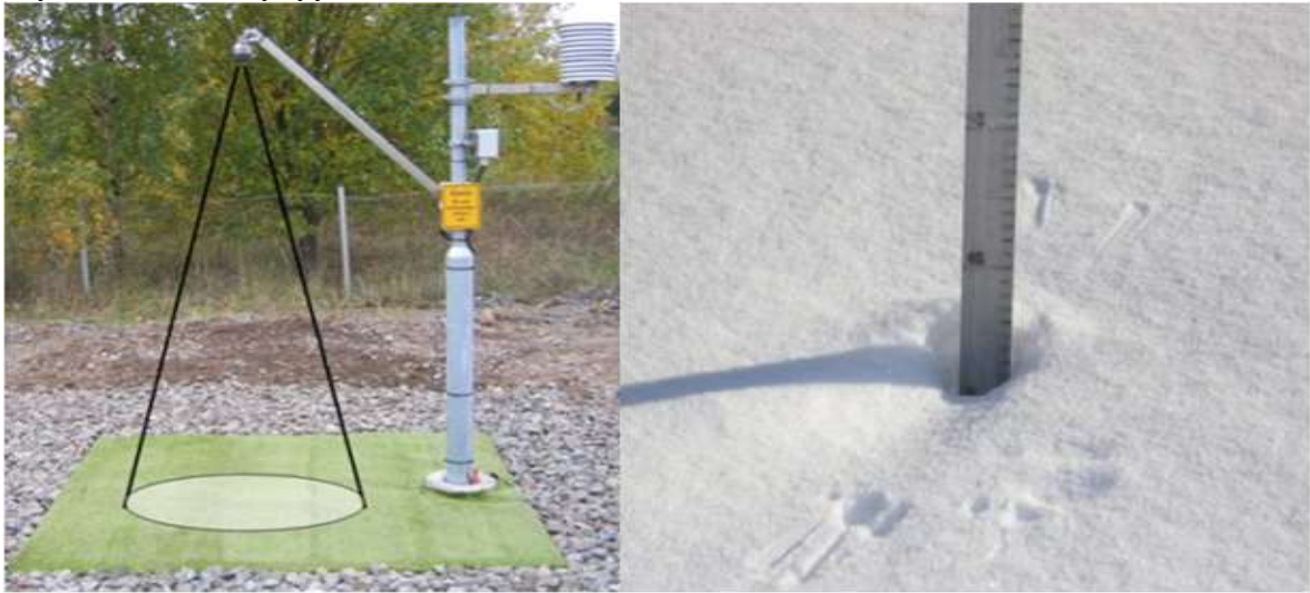
kuva 18: Lumen syvyyden mittausmenetelmiä: vasemmalla ultraäänianturi, oikealla lumisauva [sähköiset lähteet: Ilmatieteen laitos 2014b]Maanpeite- ja maankäyttöaineistot
