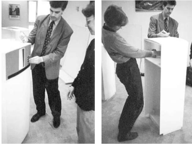
Kuva 31 Malleilla voidaan toteuttaa myös käytön simulointia laitteen toiminnan ja käyttöliittymän kehittämisessä. Kuvassa yksi tuotekehittäjistä toimii tölkkiautomaatin koneistona ja ohjelmana. Toinen toimii moderaattorina, joka ohjaa käyttäjää tässä "Ozin welho" testissä. Kuvat Simo Säde. Lisää aiheesta: Säde, 2001a, 2001b.
