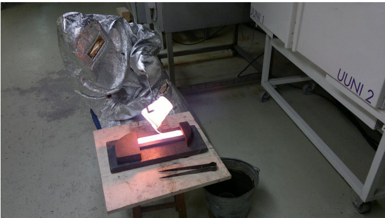
Kuva 2: Lasiseos kaadetaan upokkaasta grafiittimuottiin. Lasiharkkoon merkitään painamalla sen järjestysluku lasin ollessa vielä pehmeää. Lasiseoksia valmistessa on käytettävä kuumuudelta suojaavaa suojapukua.
