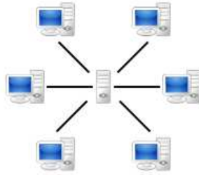
Kuva 2.4. Perinteisen palvelin-asiakas -mallin toimintaperiaate.
