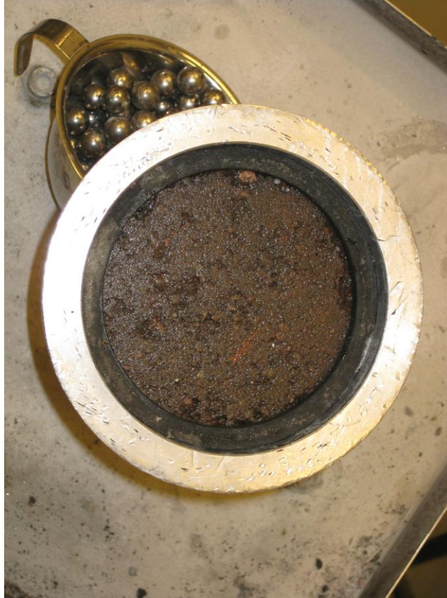
Koekappale Prall-laitteen testipesässä. Taustalla kokeessa käytetyt teräskuulat.
