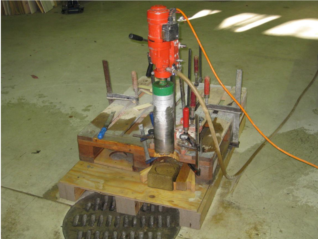
Prall-koekappaleiden valmistukseen käytetty timanttipora
