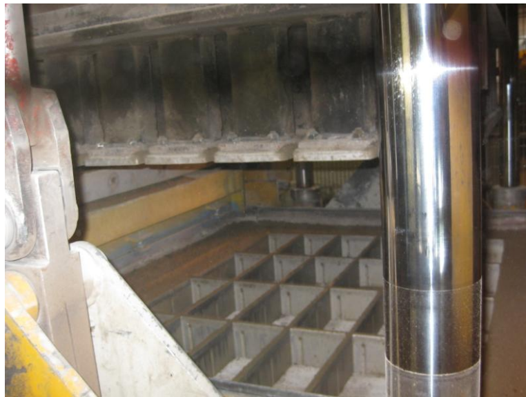
Kuva 3 Tyhjä muotti betonikivikoneen sisällä. Hydraulinen täyttölaatikko liikkuu sivuttaissuunnassa muotin päälle ja annostelee massan muottiin. Tämän jälkeen kuvan yläreunassa näkyvät pistimet eli tamperit laskeutuvat muotin päälle ja puristavat massaa kasaan.
