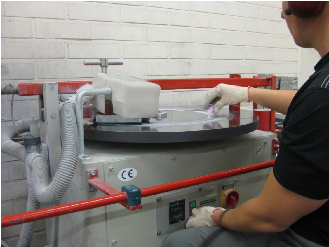
Böhme-laite. Koekappale on testausradan vasemmassa laidassa olevassa pitimessä.
