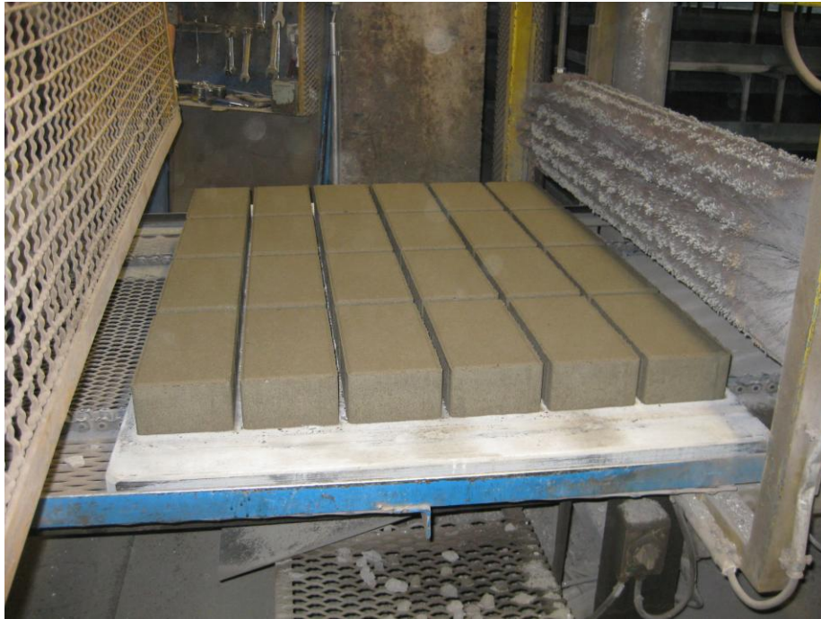
Kuva 1 Valmiit kivet kulkevat ennen jälkihoitoon menoa metalliharjasten läpi. Harjakset poistavat kiven reunaviisteisiin jääneen ylimääräisen massan. Tällaisia massajäämiä voi syntyä käytettäessä vanhoja muotteja.
