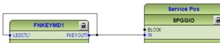
Kuva 32: Tuotantoyksikön katkaisijan käyttötilan kytkeminen digitaaliseen mittauslohkoon, josta se voidaan lähettää PML630:lle.
